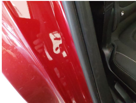
Türeinstieg / Hinten Rechts / Delle
