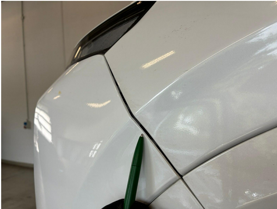
Bild 9 : Stoßfänger vorne + Kotflügel links Kratzer + Verformung, Schadenerweiterung nach Demontage möglich
