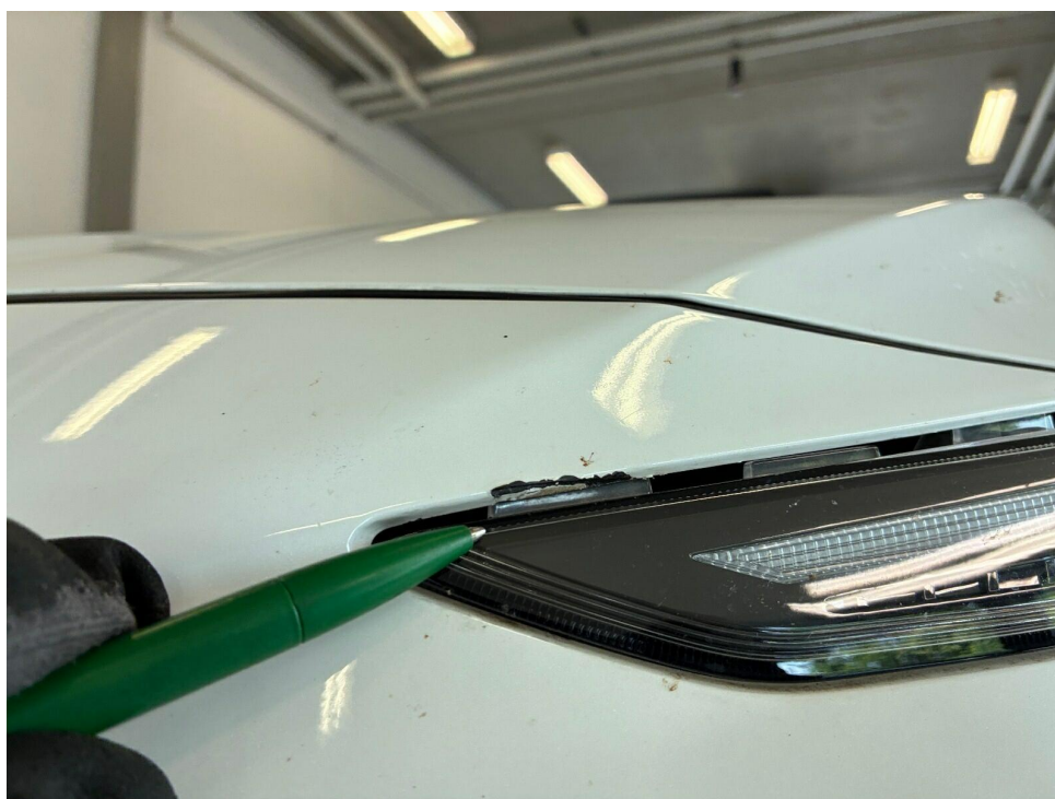
Bild 12 : Stoßfänger vorne + Kotflügel links Kratzer + Verformung, Schadenerweiterung nach Demontage möglich
