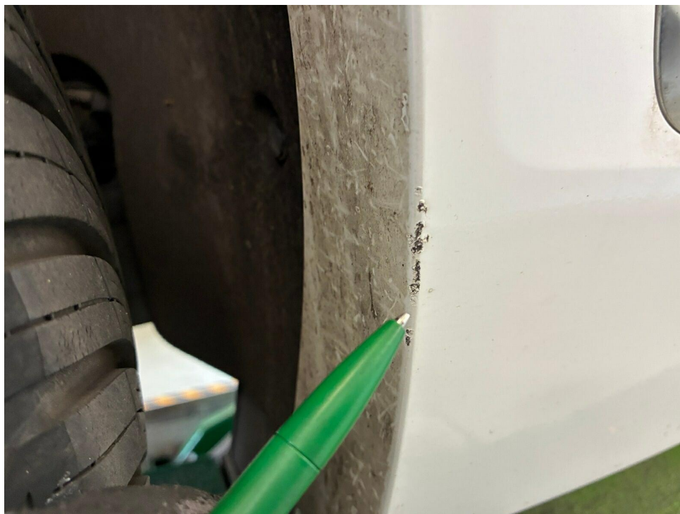
Bild 19 : Türe hinten rechts Kratzer Blende
