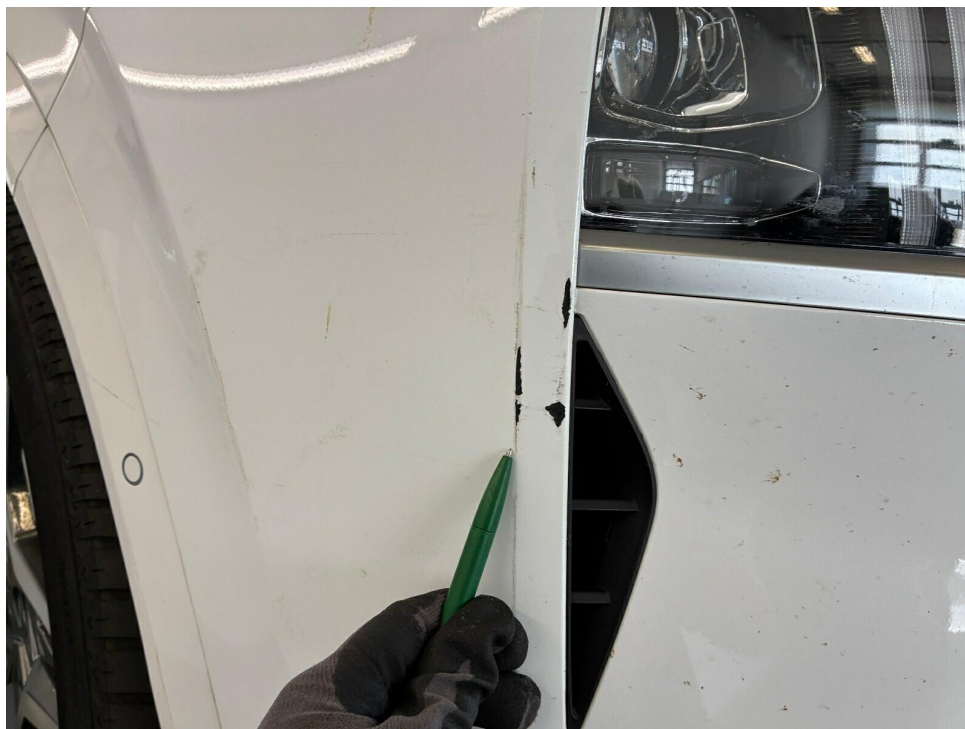
Bild 15 : Stoßfänger vorne + Kotflügel links Kratzer + Verformung, Schadenerweiterung nach Demontage möglich
