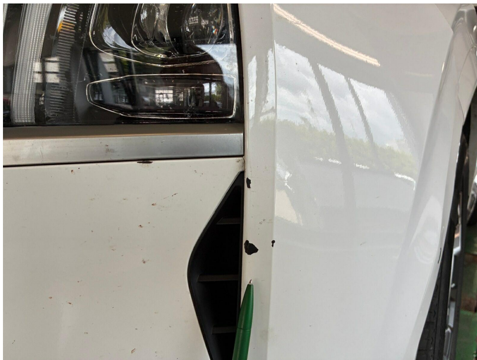
Bild 11 : Stoßfänger vorne + Kotflügel links Kratzer + Verformung, Schadenerweiterung nach Demontage möglich
