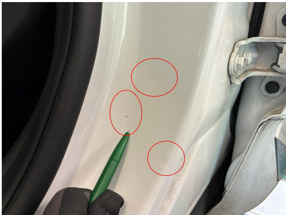
Bild 22 : Einstieg vorne links Kratzer + Dellen
