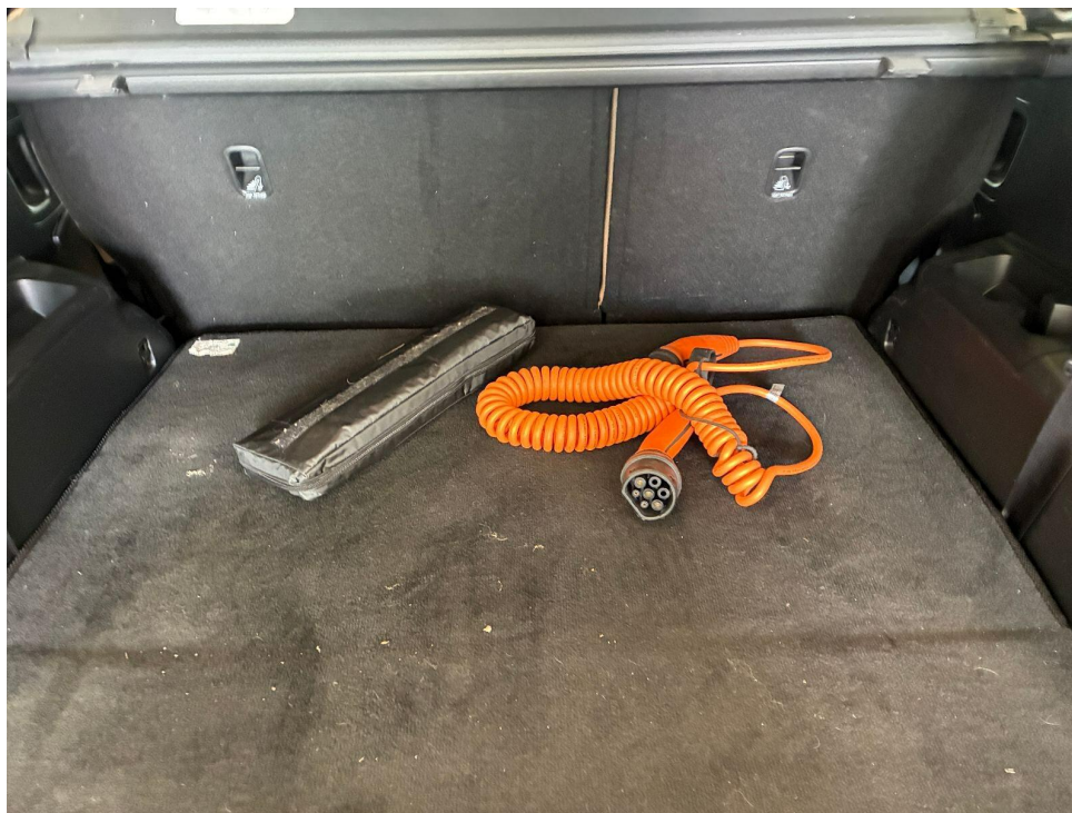
Bild 6 : Ladekabel beim E-Fahrzeug
