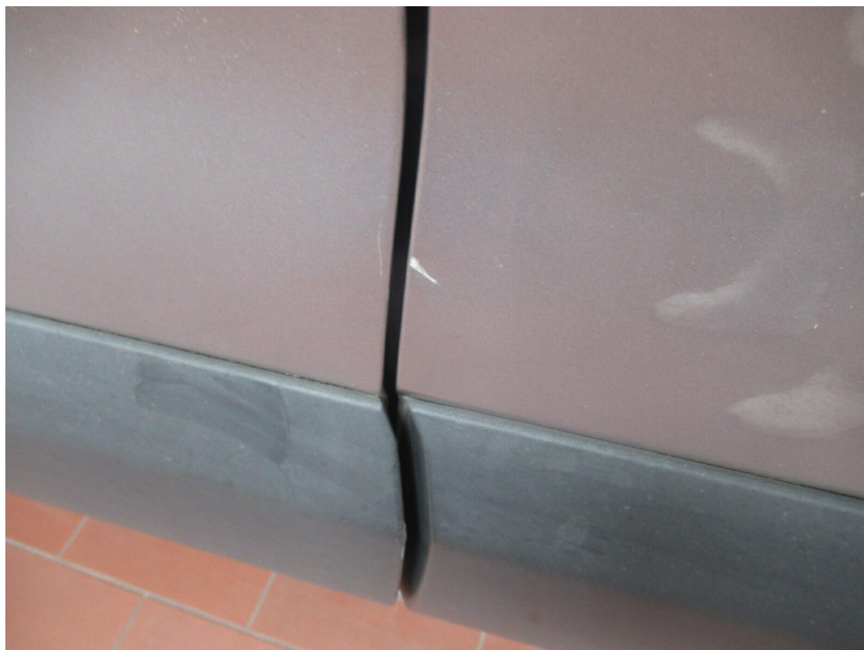
Bild 8 : Tür hinten links zerkratzt
