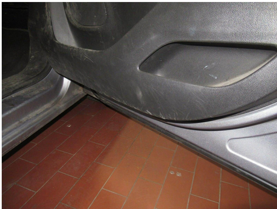
Bild 14 : Türverkleidung vorne rechts verschrammt
