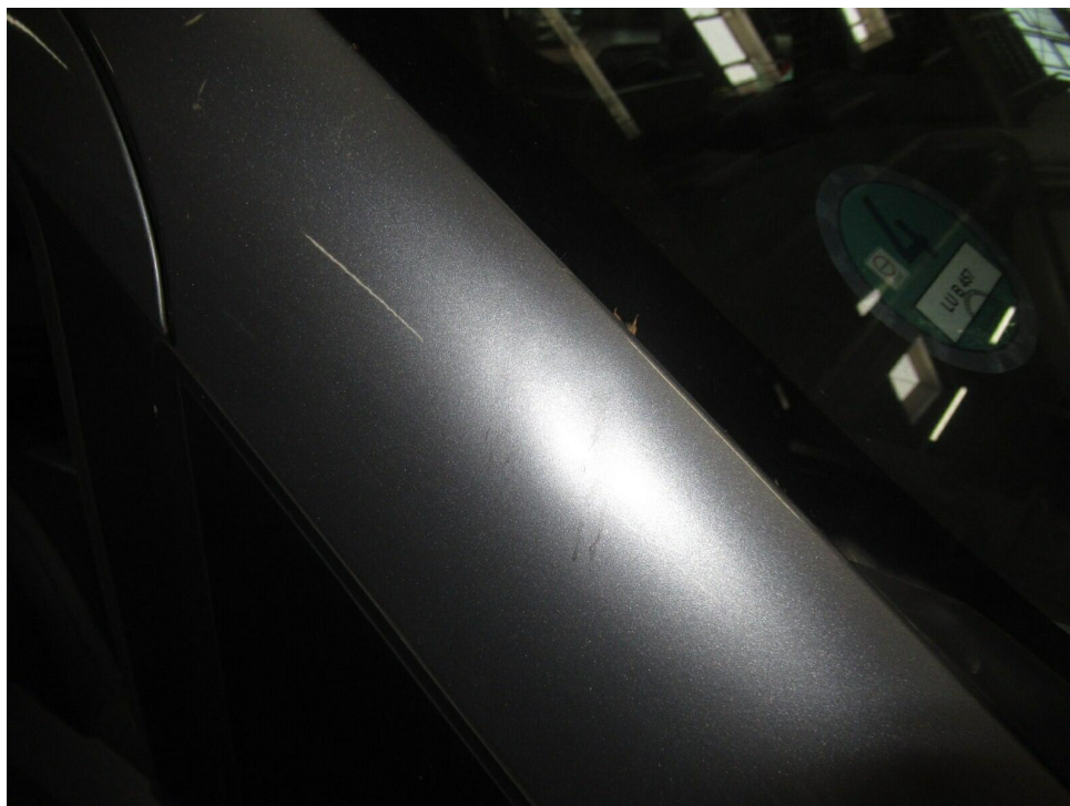
Bild 12 : A-Säule rechts eingedellt, zerkratzt
