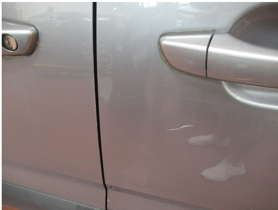
Bild 7 : Tür hinten links zerkratzt
