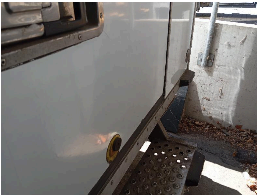
Bild: 37 Anschlagpuffer Koffertür hinten fehlt
