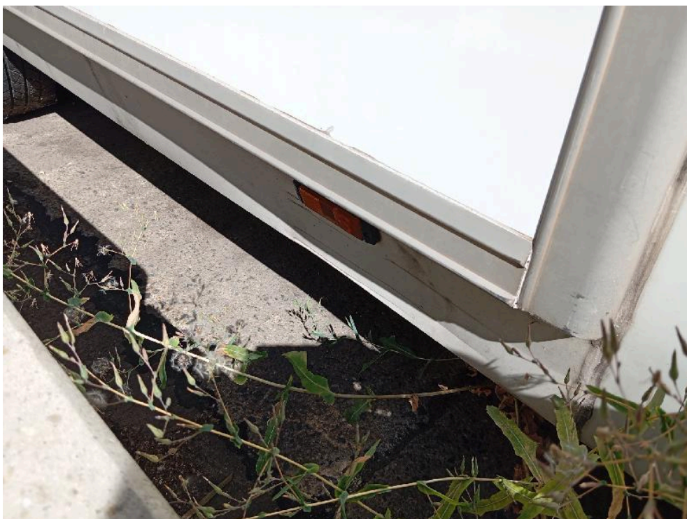
Bild: 32 Unterfahrschutz rechts Delle
