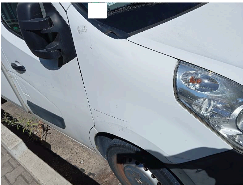
Bild: 22 Kotflügel vorn rechts Delle
