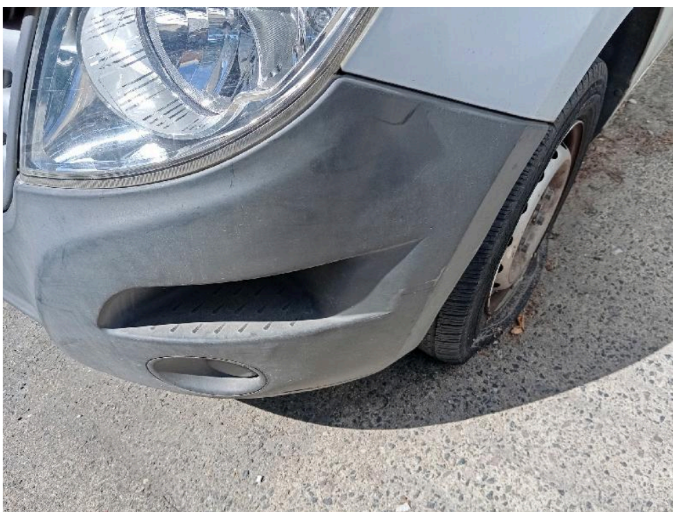
Bild: 16 Stoßfänger vorn verformt und gebrochen
