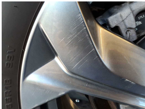
Beschädigung #1: Rad/Reifen: Leichtmetallfelge hinten links - Kratzer - lackieren
