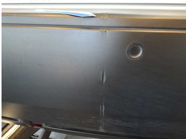
Beschädigung #5: Stossfänger hinten: Stossfänger hinten - verformt - erneuern
