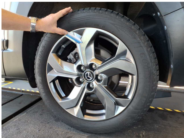
Beschädigung #1: Rad/Reifen: Leichtmetallfelge hinten links - Kratzer - lackieren
