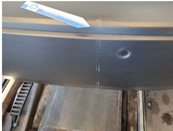
Beschädigung #5: Stossfänger hinten: Stossfänger hinten - verformt - erneuern
