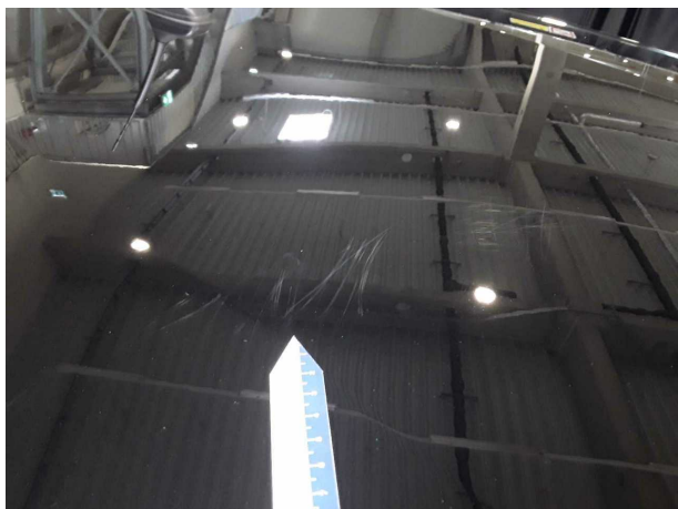
Beschädigung #3: Fahrzeugdach: Dach - Kratzer - lackieren
