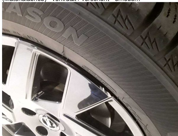
Beschädigung #1: Rad/Reifen: Leichtmetallfelge vorn links (Materialabrieb) - verkratzt / verschürft - erneuern
