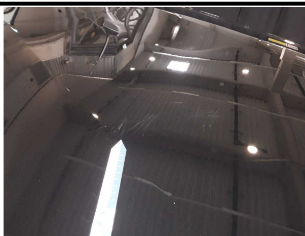
Beschädigung #3: Fahrzeugdach: Dach - Kratzer - lackieren
