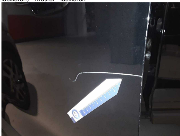
Beschädigung #4: Tür hinten links: Tür (inklusive vordere Tür lackieren) - Kratzer - lackieren
