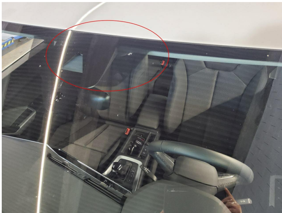
Bild 14 : Frontscheibe, Steinschlag mit Rissbildung
