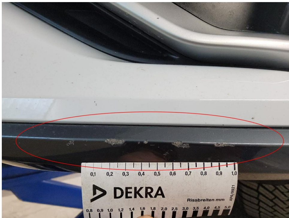
Bild 17 : Frontspoiler Lackierung, verschrammt, lackieren mit Lackaufbau
