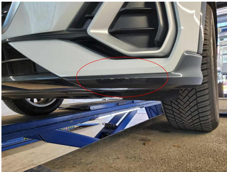
Bild 16 : Frontspoiler Lackierung, verschrammt, lackieren mit Lackaufbau
