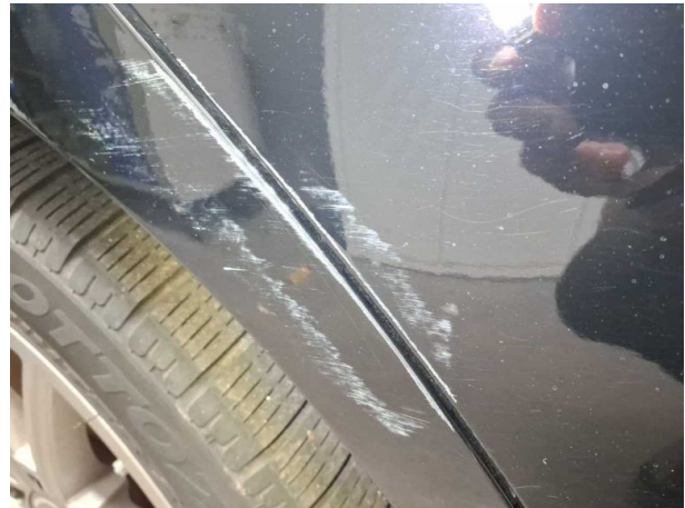
Beschädigung #11: Tür hinten rechts: Tür - verkratzt / verschürft - instandsetzen und lackieren
