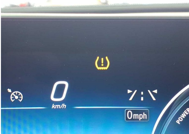
Beschädigung #4: Rad/Reifen: Drucksensor (Fehlermeldung) - Diagnose durchführen
