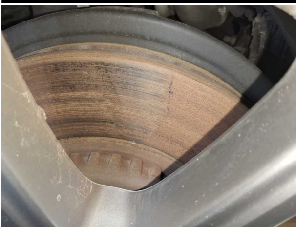
Beschädigung #9: Bremsanlage: Bremsscheiben und Beläge hinten - Korrosion - erneuern
