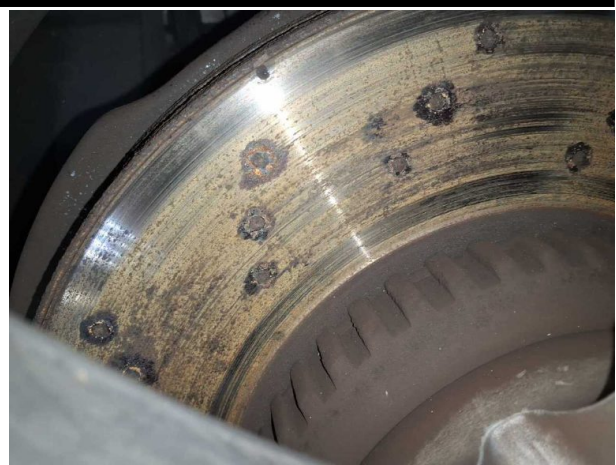
Beschädigung #10: Bremsanlage: Bremsscheiben und Beläge vorn - Korrosion - erneuern
