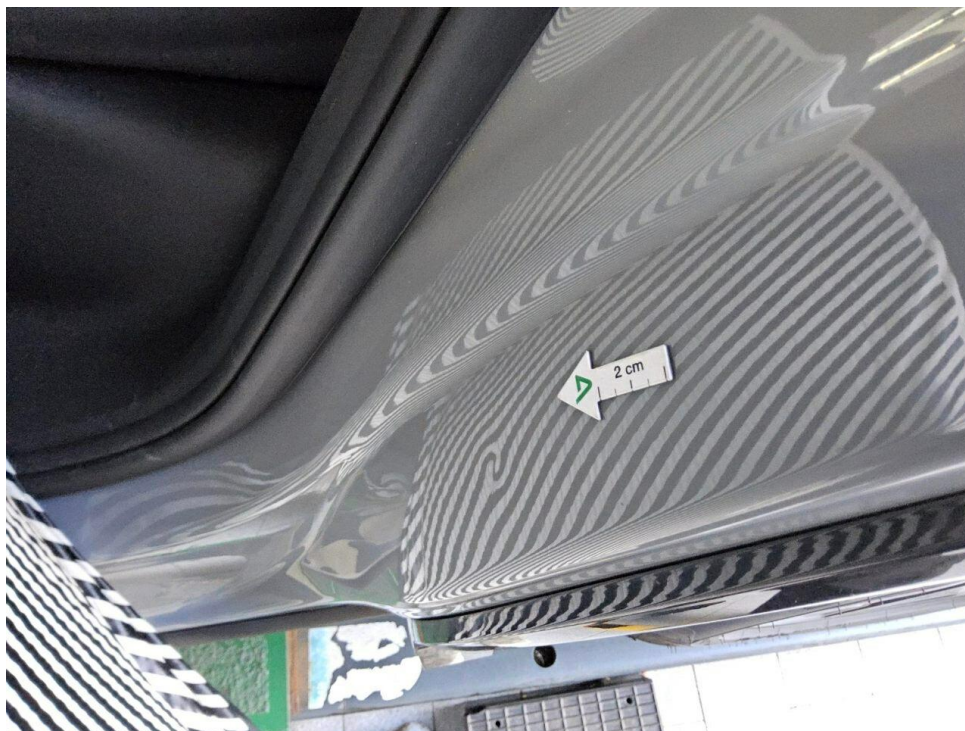
Bild 14 : Tür hinten links Einstieg, eingedellt, drücken
