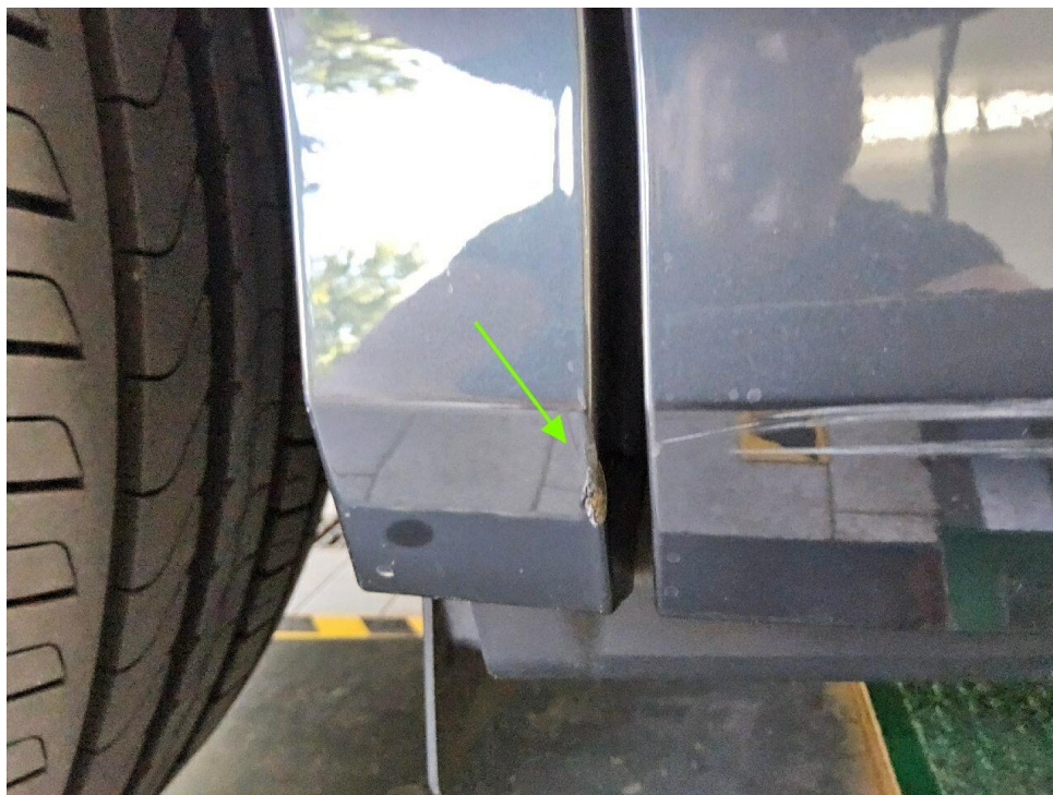
Bild 31 : Seitenteil hinten rechts Lackierung, zerkratzt, smart repair
