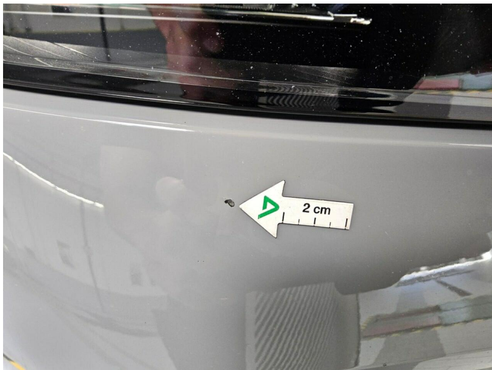
Bild 8 : Stoßfänger vorne Lackierung, Steinschlag, smart repair
