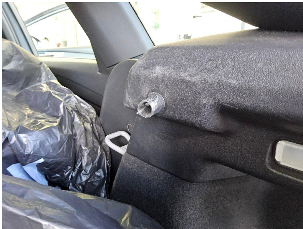
Bild 29 : Kofferraum, Seitenverkleidung rechts, Hutablagenaufnahme, gebrochen
