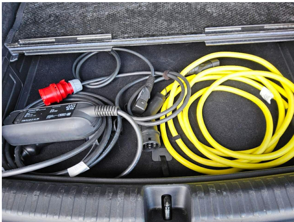
Bild 7 : Ladekabel beim E-Fahrzeug
