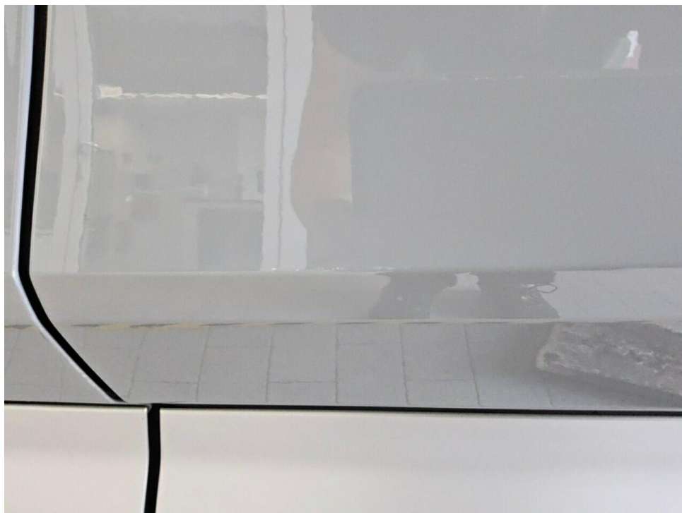
Bild 16 : Tür hinten links Lackierung, verschrammt, polieren
