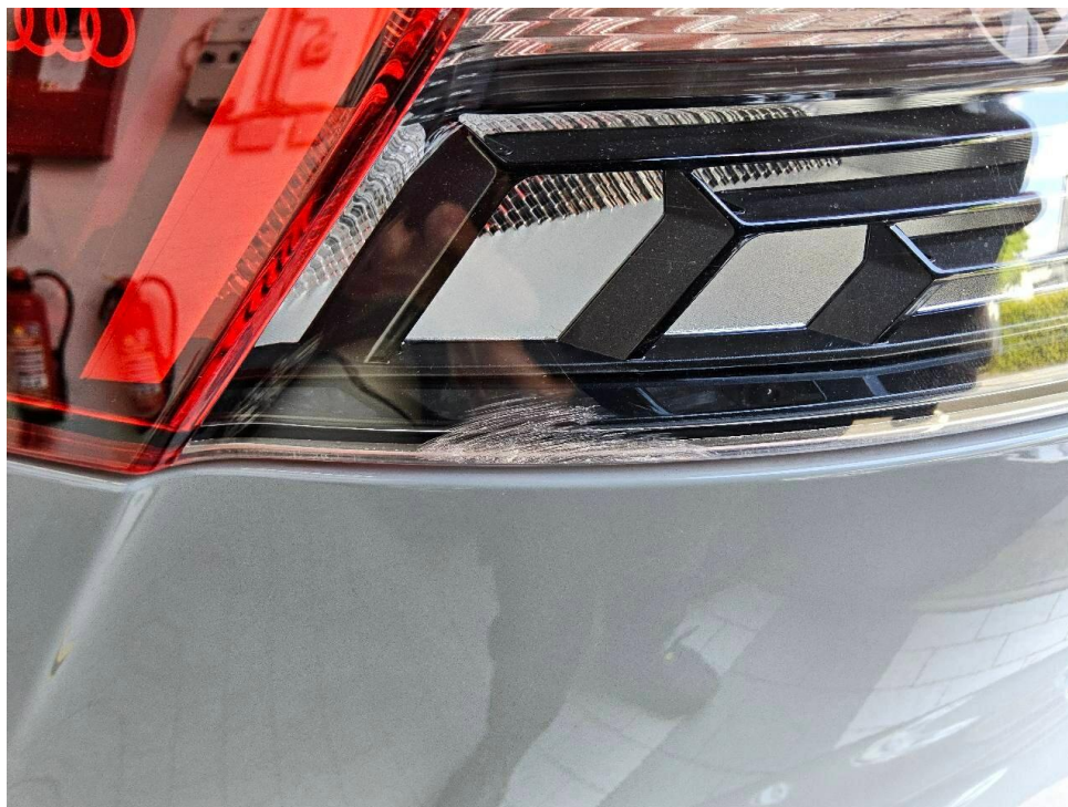
Bild 27 : Rücklicht links außen, zerkratzt
