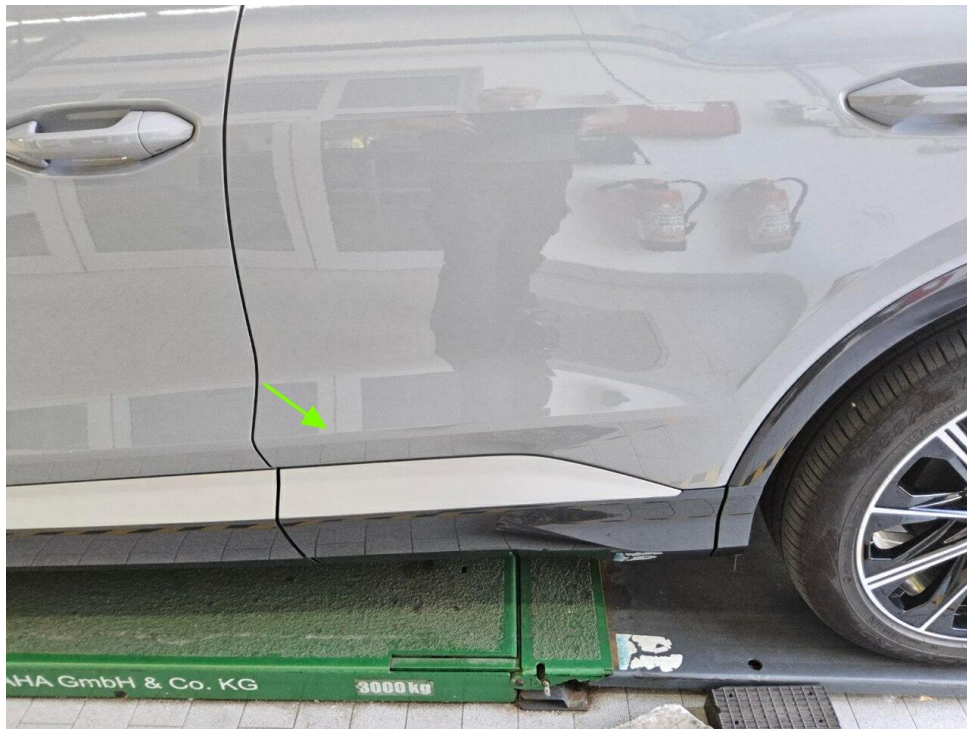
Bild 17 : Tür hinten links Lackierung, verschrammt, polieren
