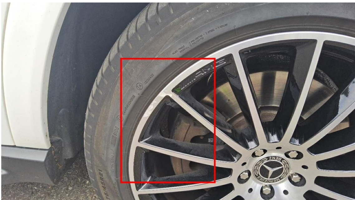
Bild 20 : Alufelge vorne rechts beschädigt
