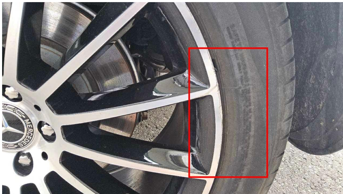
Bild 23 : Alufelge hinten links Kratzer
