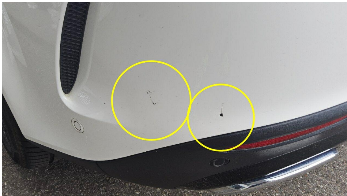
Bild 29 : Stoßfängerverkleidung hinten Kratzer
