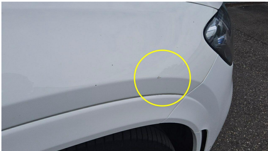
Bild 33 : Kotflügel vorne rechts Kratzer
