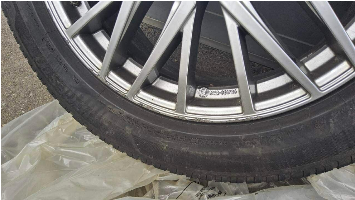
Bild 17 : 1 Alufelge WR beschädigt
