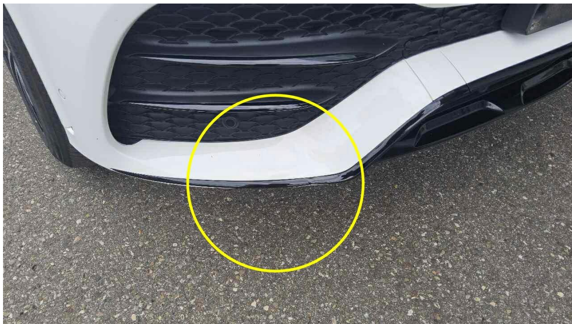
Bild 31 : Stoßfängerleiste vorne Druckstelle
