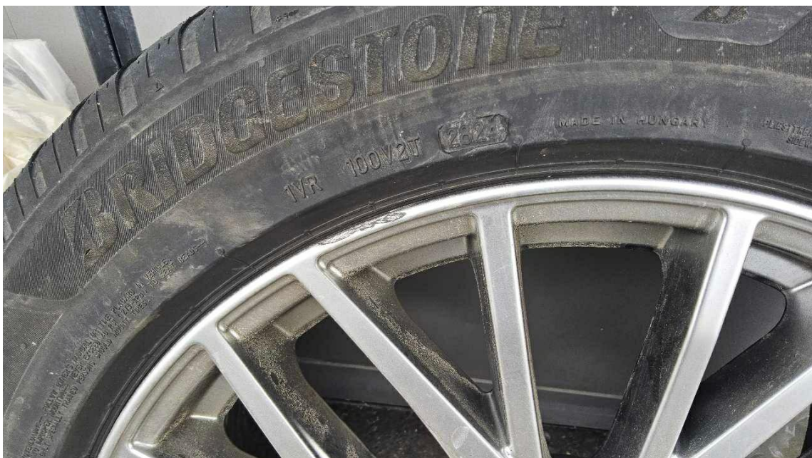
Bild 18 : 2 Alufelge WR beschädigt
