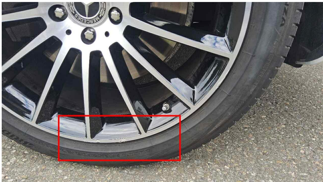
Bild 21 : Alufelge vorne rechts beschädigt
