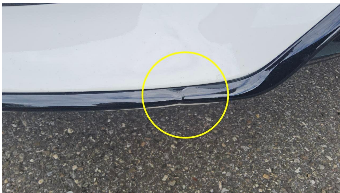
Bild 30 : Stoßfängerleiste vorne Druckstelle
