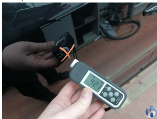
1. Tür Vorne - Links Nachlackiert - Ohne Reparatur
