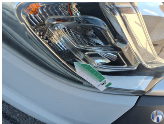
7. Scheinwerfer Halogen - Rechts Kratzer - Erneuern
