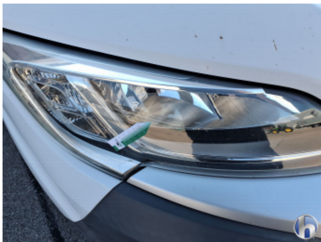
7. Scheinwerfer Halogen - Rechts Kratzer - Erneuern
