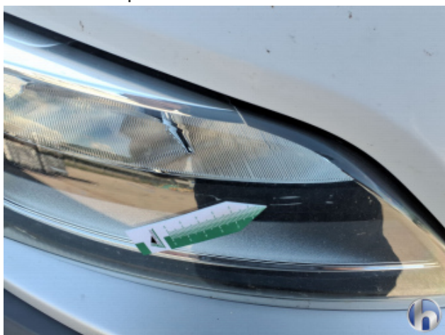
7. Scheinwerfer Halogen - Rechts Kratzer - Erneuern
