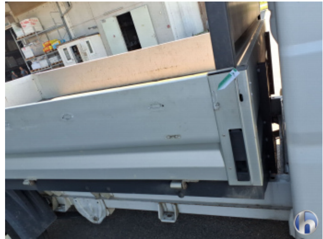
8. Bordwand Fehlt - Erneuern
