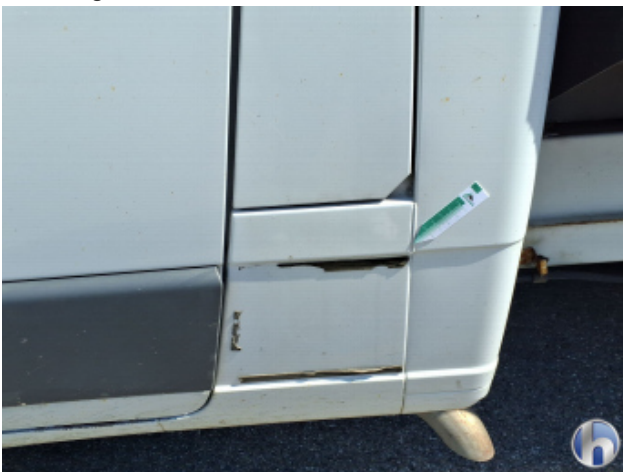
2. Schweller - Links Fehlt - Erneuern
