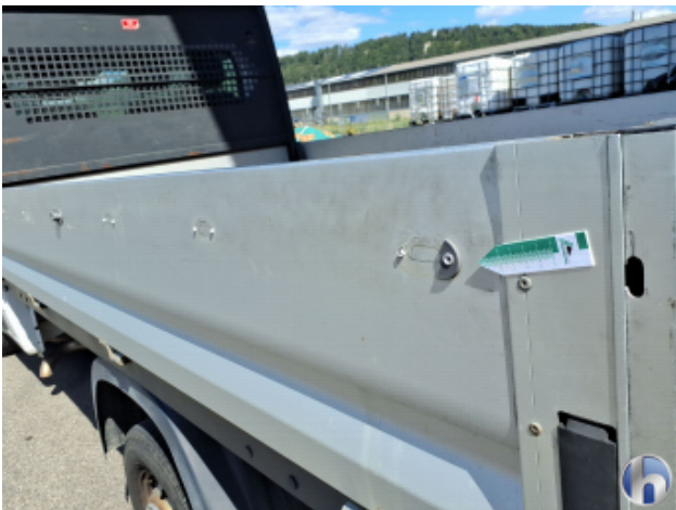
8. Bordwand Fehlt - Erneuern
