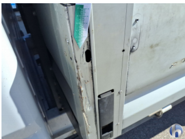
1. Seitenwand - Hinten - Links Beschädigt - Instandsetzen und Lackieren
