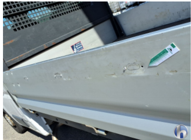
8. Bordwand Fehlt - Erneuern
