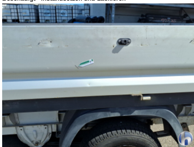
1. Seitenwand - Hinten - Links Beschädigt - Instandsetzen und Lackieren
