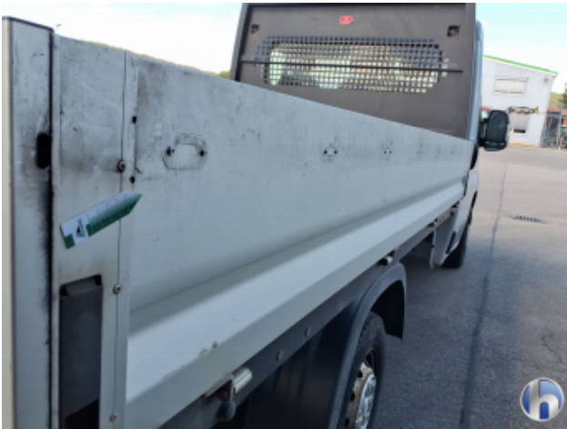
8. Bordwand Fehlt - Erneuern
