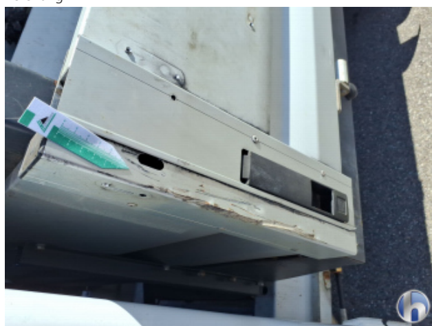
1. Seitenwand - Hinten - Links Beschädigt - Instandsetzen und Lackieren
