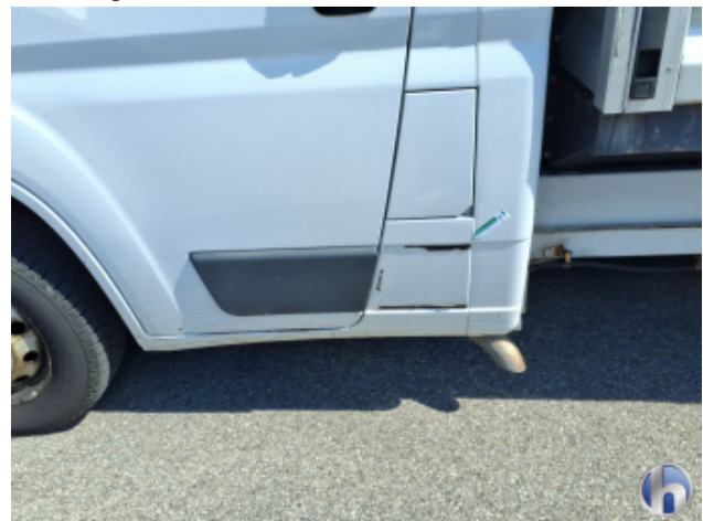
2. Schweller - Links Fehlt - Erneuern
