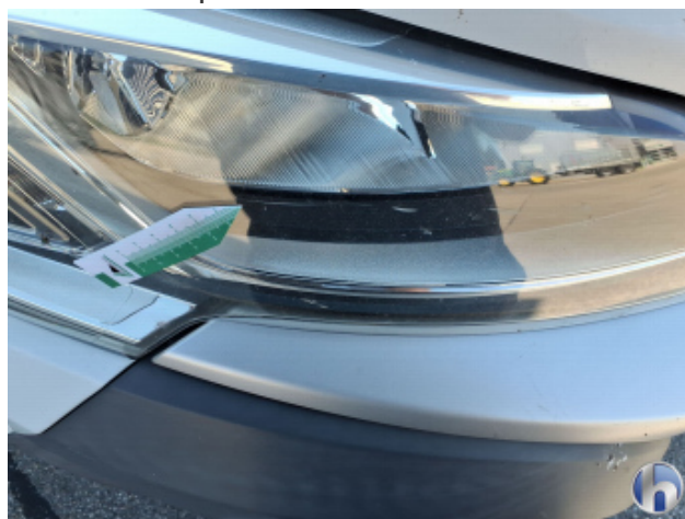
7. Scheinwerfer Halogen - Rechts Kratzer - Erneuern
