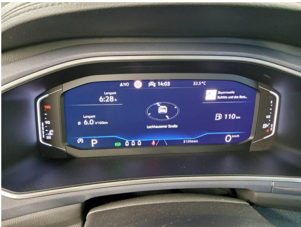
Bild 6 : Kombiinstrument (betriebsbereit) mit Km-Stand
