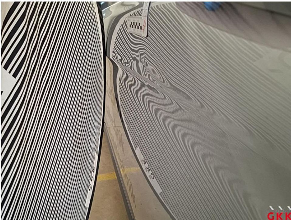
Bild 24 Seitenwand links, beschädigt, instand setzen - lackieren
