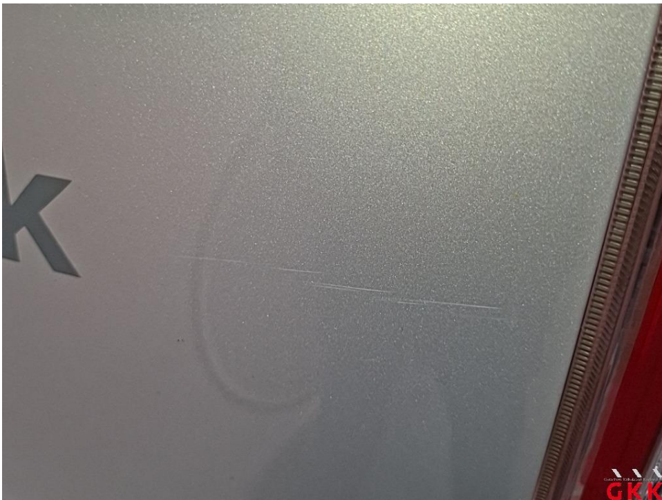
Bild 26 Heckklappe, beschädigt, instand setzen - lackieren
