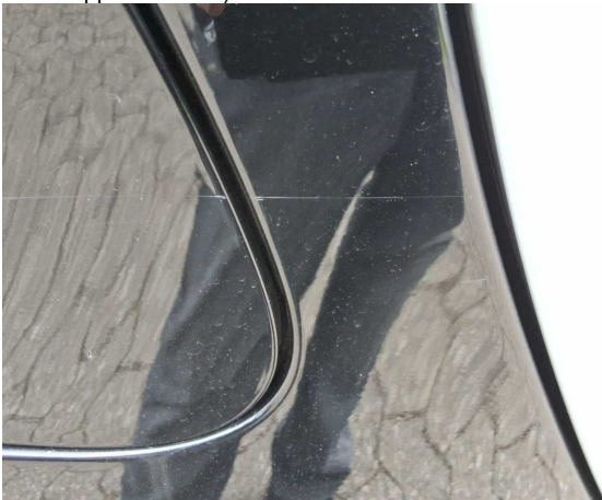
Beschädigung #2: Seitenwand rechts: Seitenwand (inklusive Ladeklappe lackieren) - Kratzer - lackieren
