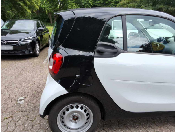
Beschädigung #2: Seitenwand rechts: Seitenwand (inklusive Ladeklappe lackieren) - Kratzer - lackieren
