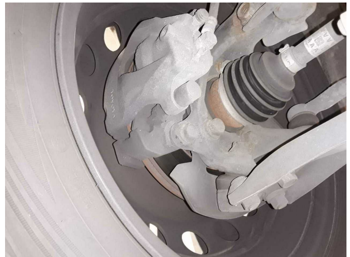
Damage 8: Braking system: Brake discs and brake pads - front (Bremsscheiben sind eingelaufen und) - Worn - Replace
