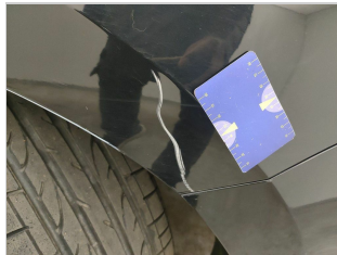
Deur Voorkant Rechts // Reparatie & Schilderen: AA - Kras + deuk
