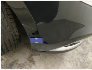
Voorkant / Parkeersensor / Vervangen: R - Ontbreekt
