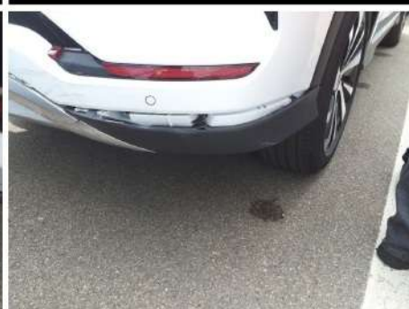
Parte inferiore paraurti / Posteriore / Rotto
