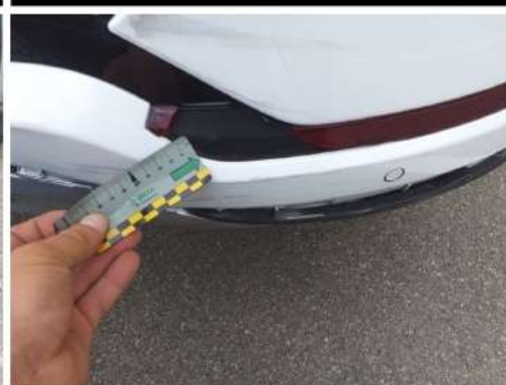
Catadio ttro / Posteriore Destro / Rotto
