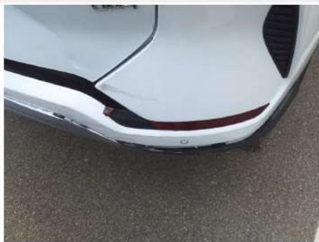
Catadiottro / Posteriore Destro / Rotto
