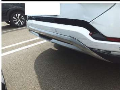
Spoiler / Posteriore / Rotto
