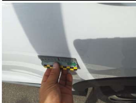
Porta / Posteriore Sinistro / Ammaccato vernice incisa
