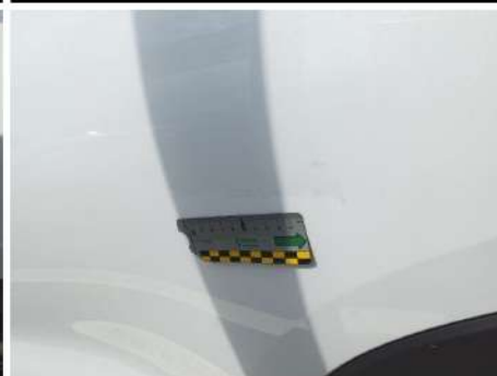
Porta / Posteriore Sinistro / Ammaccato vernice incisa
