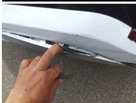
Spoiler / Posteriore / Rotto
