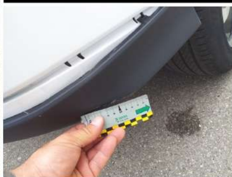
Parte inferiore paraurti / Posteriore / Rotto
