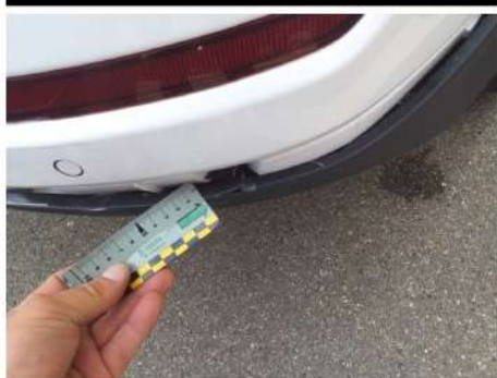
Parte inferiore paraurti / Posteriore / Rotto
