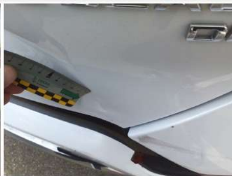
Portello / Posteriore / Ammaccato vernice incisa
