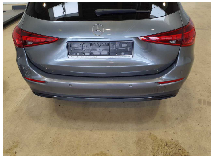
Damage 9: Rear bumper: Rear bumper (Zusätzlich Kratzer Blende und Spoiler) - Dent / paintcoat damage - Repair and paint
