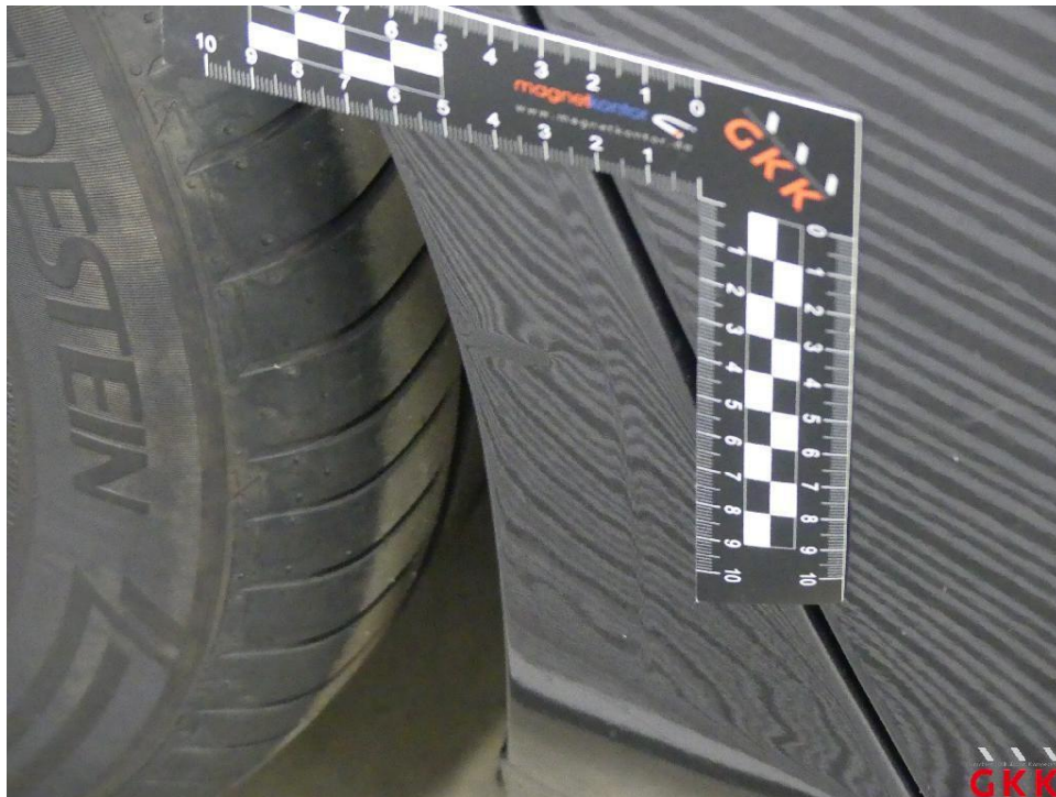
Bild 24 Seitenwand rechts, beschädigt, instand setzen - lackieren
