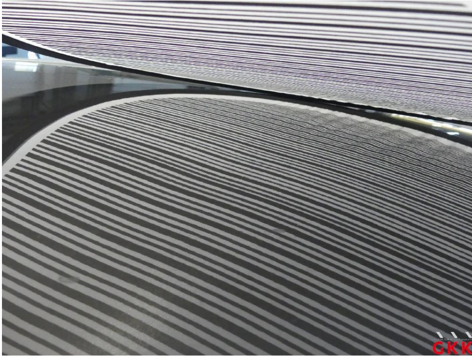
Bild 17 Fahrzeug, Hagelschaden, kalt drücken
