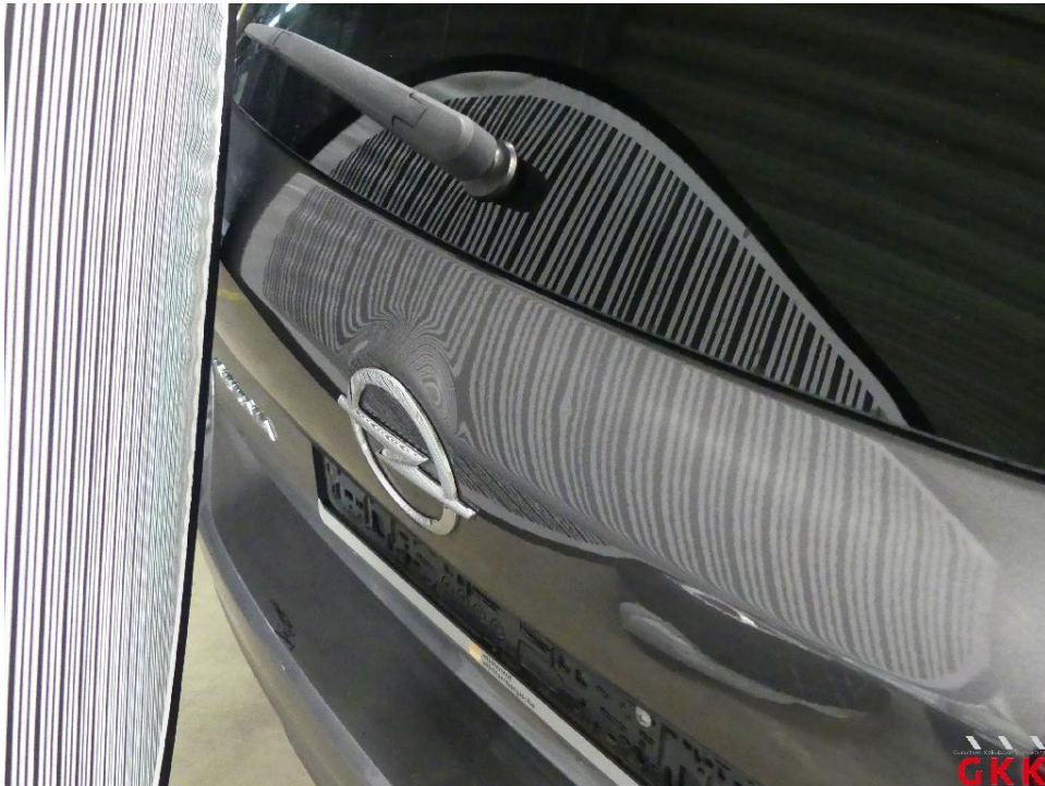
Bild 21 Fahrzeug, Hagelschaden, kalt drücken
