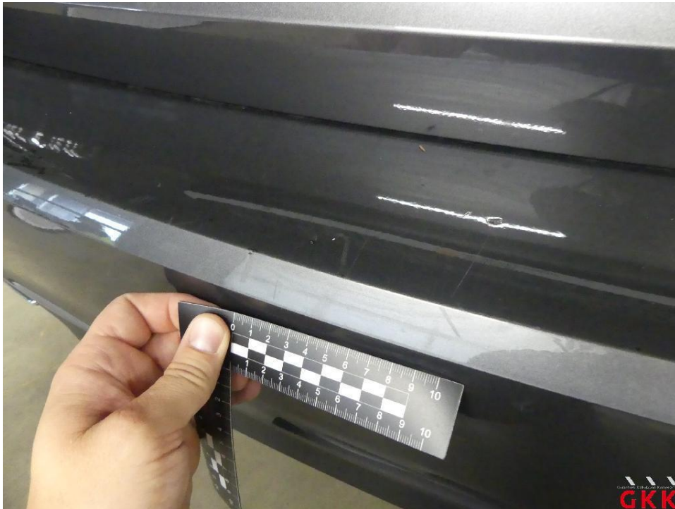
Bild 25 Stoßfänger hinten, Verkleidung -lackiert-, verkratzt, lackieren
