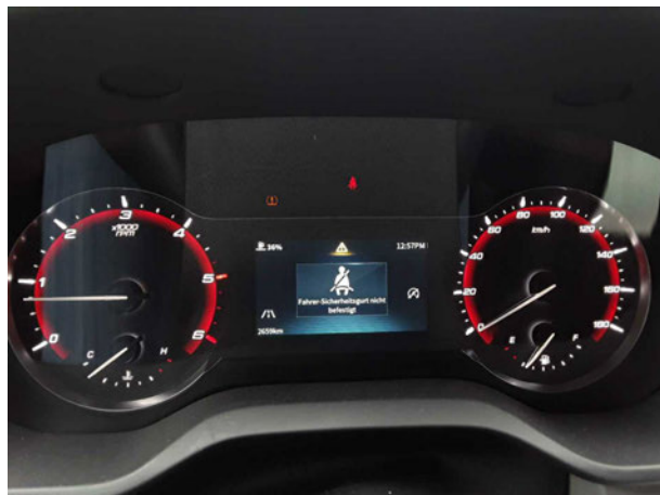
Beschädigung #1: Instrumententafel: Kontrollleuchte (Reifendruck) - leuchtet - befunden ggf. instandsetzen
