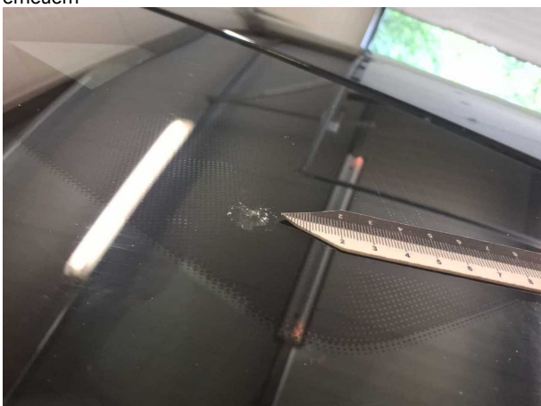
Beschädigung #2: Verglasung: Frontscheibe - Steinschlag - erneuern
