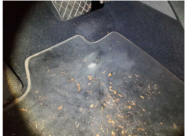
Beschädigung #1: Verkleidungen/Abdeckungen: Fußmatten - beschädigt - erneuern
