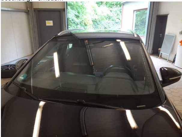
Beschädigung #2: Verglasung: Frontscheibe - Steinschlag - erneuern
