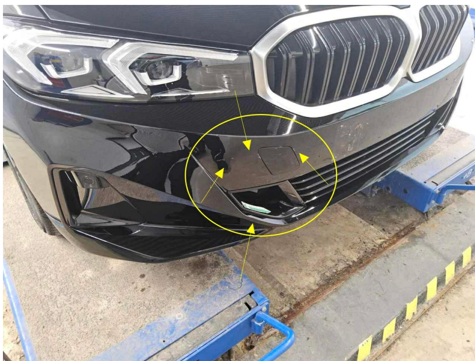
Bild 16 : Stoßfänger vorne, eingedellt, instandsetzen und lackieren mit Lackaufbau
