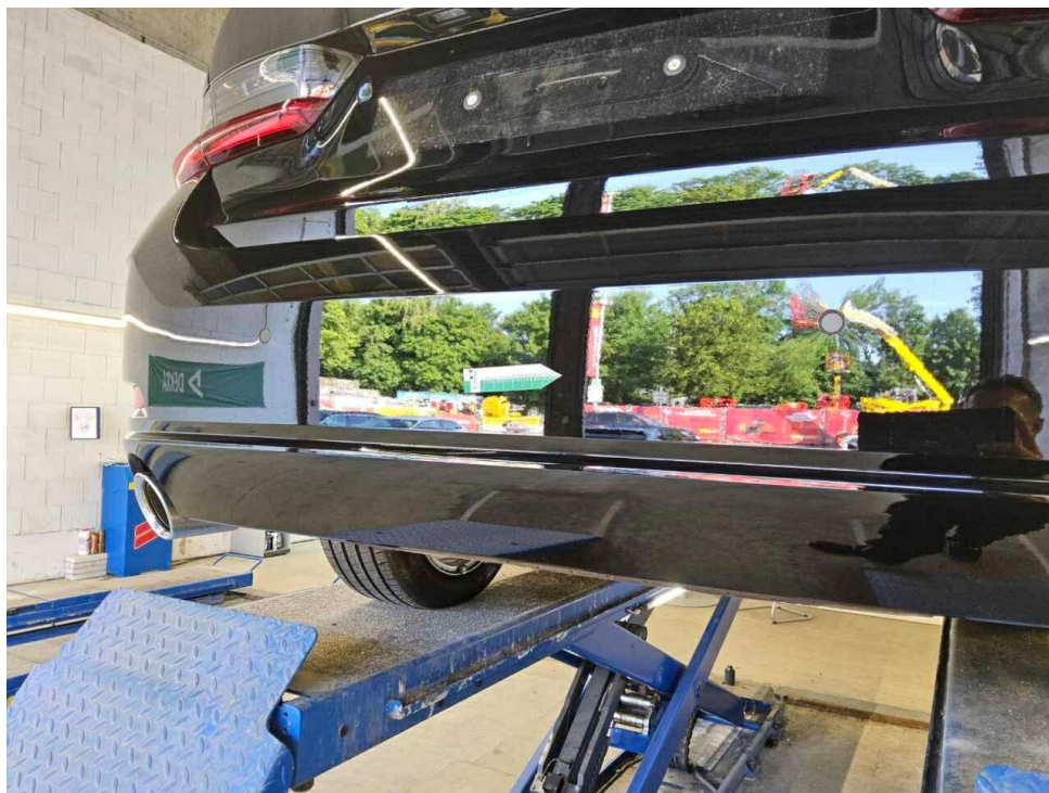
Bild 14 : Stoßfänger hinten, eingedellt, Gebrauchsspur
