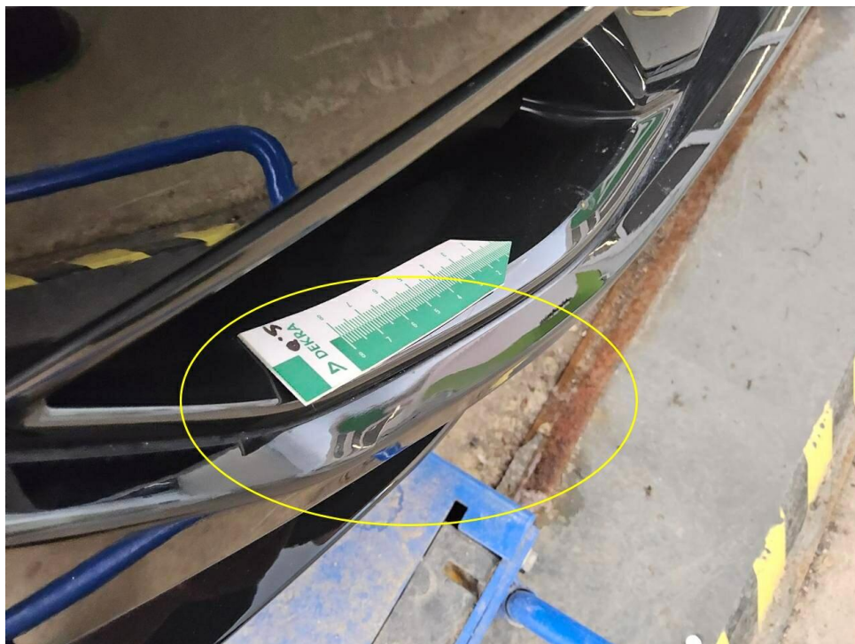
Bild 18 : Stoßfänger vorne, eingedellt, instandsetzen und lackieren mit Lackaufbau
