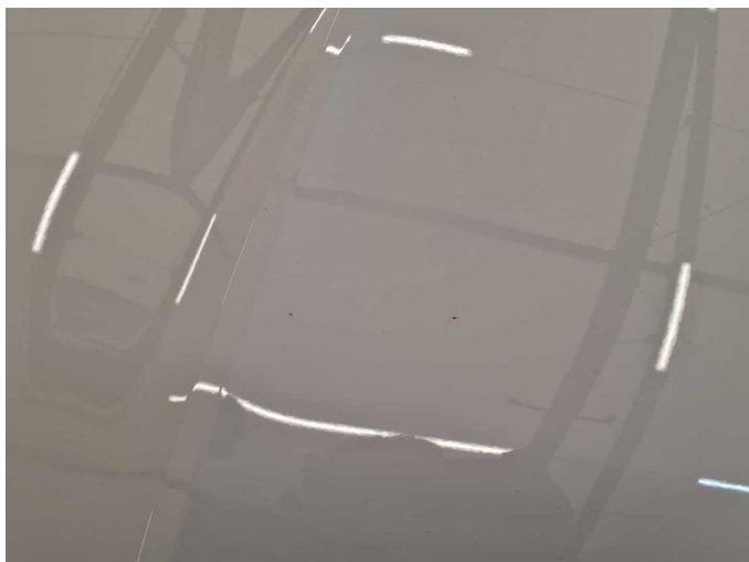
Wear and tear 3: Bonnet: Bonnet (Flugrost auf Motorhaube keine Lackbeschädigung) - Stone chips - No deduction
