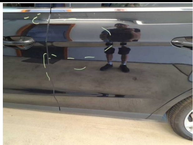
Beschädigung #5: Tür hinten links: Tür - verkratzt / verschürft... auslegen / polieren
