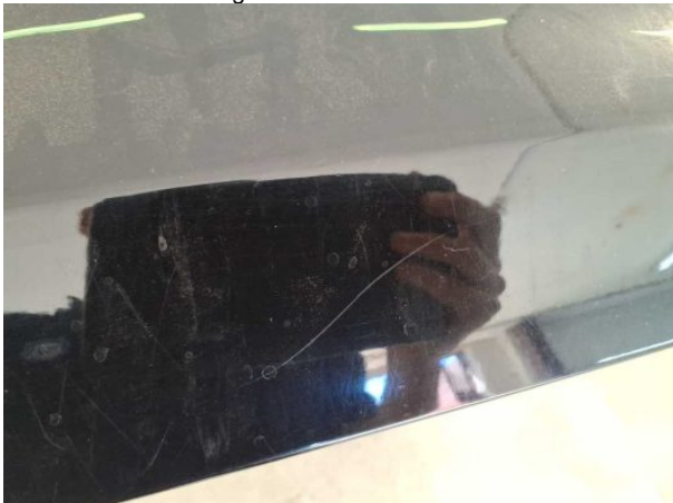
Beschädigung #3: Heckklappe/-tür: Heckklappe - verkratzt / verschürft - auslegen / polieren
