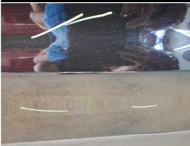
Beschädigung #13: Tür vorn rechts: Tür - verkratzt / verschürft - instandsetzen und lackieren
