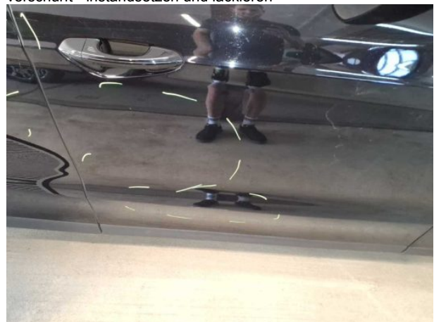
Beschädigung #13: Tür vorn rechts: Tür - verkratzt / verschürft - instandsetzen und lackieren
