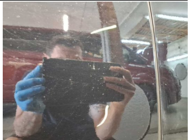
Beschädigung #12: Tür hinten rechts: Tür - verkratzt / verschürft - instandsetzen und lackieren
