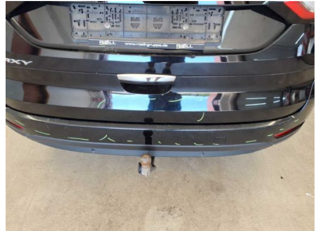
Beschädigung #3: Heckklappe/-tür: Heckklappe - verkratzt / verschürft - auslegen / polieren
