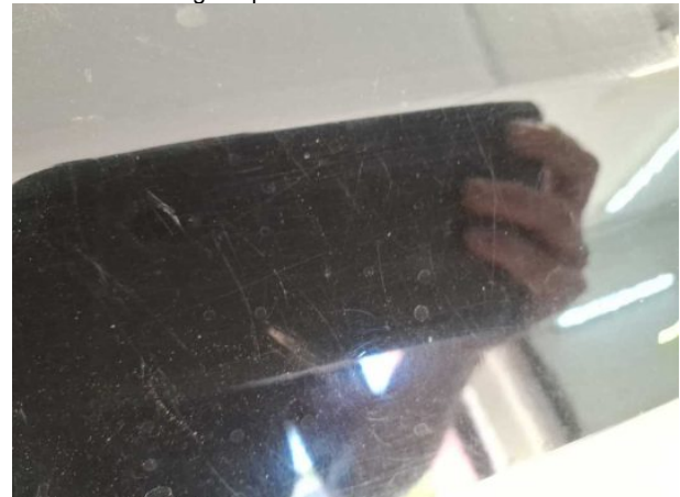
Beschädigung #3: Heckklappe/-tür: Heckklappe - verkratzt / verschürft - auslegen / polieren
