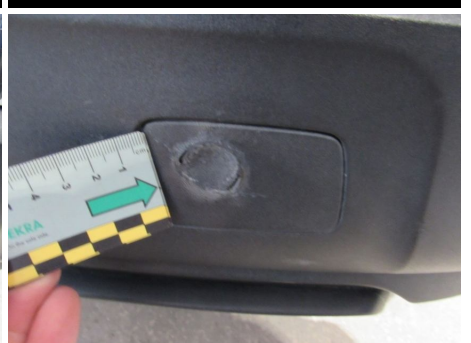
Tappo paraurti / Posteriore / Difetto di Esecuzione
