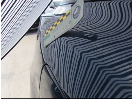
Parafango / Posteriore Destro / Rientranza
