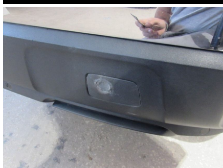
Tappo paraurti / Posteriore / Difetto di Esecuzione
