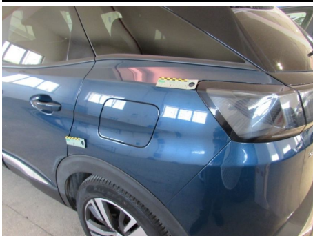
Parafango / Posteriore Sinistro / Ammaccato vernice incisa
