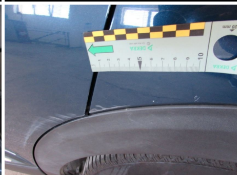
Parafango / Posteriore Sinistro / Ammaccato vernice incisa
