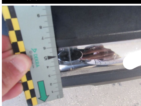
Modanatura paraurti / Posteriore / Rotto
