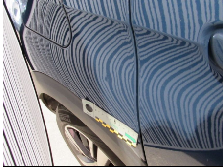
Parafango / Posteriore Destro / Rientranza
