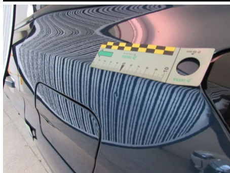
Parafango / Posteriore Sinistro / Ammaccato vernice incisa
