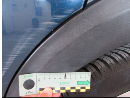
Modanatura parafrango / Posteriore Sinistro / Riga
