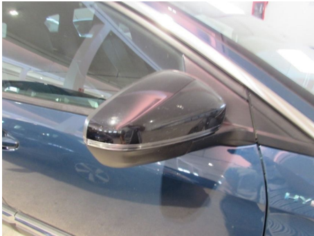
Calotta retrovisore / Destro / Riga
