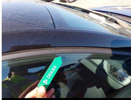
Junta de ventana / Delantero Derecho / Roto
