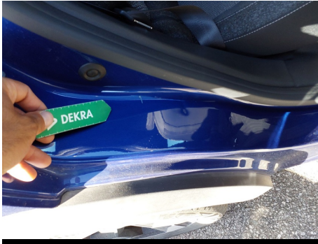
Travesaño de la puerta / Trasero Derecho / Abolladura
