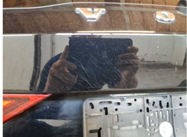
Beschädigung #1: Heckklappe/-tür: Heckklappe - verkratzt / verschürft - Smart Repair
