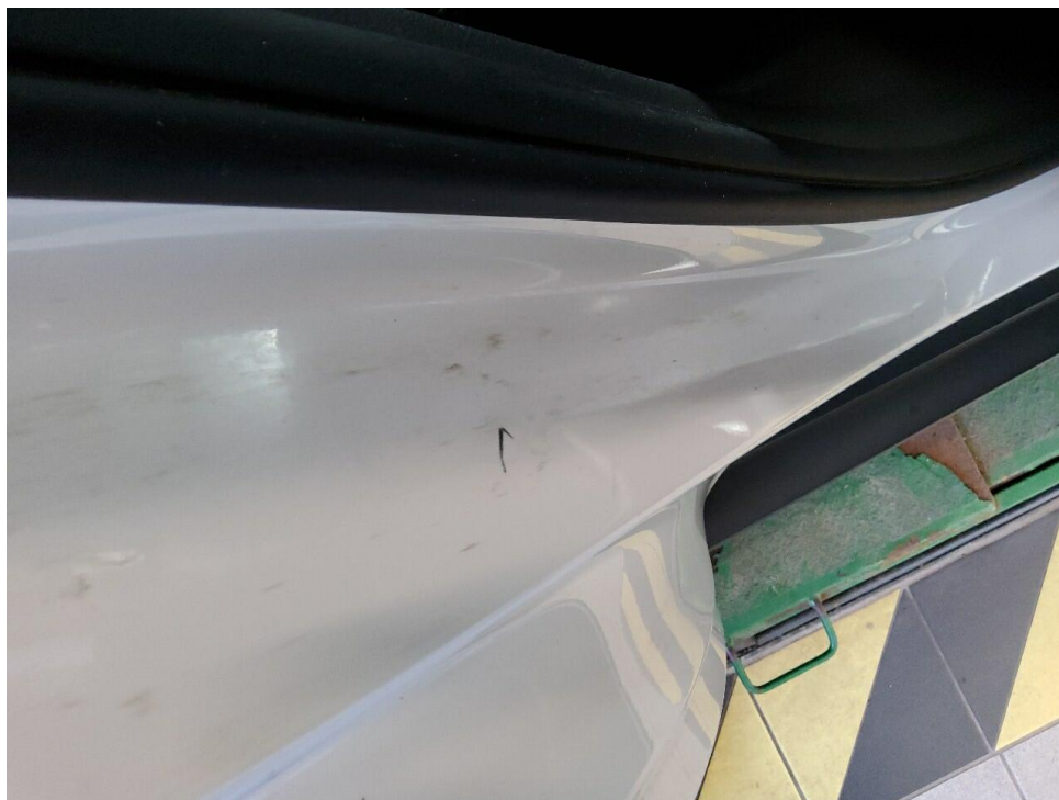
Bild 7 : Türeinstieg hinten rechts Kratzer
