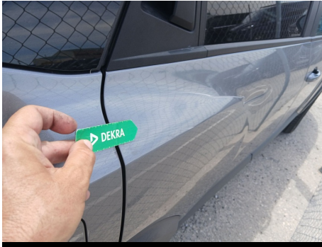
Puerta / Trasero Derecho / Abolladura
