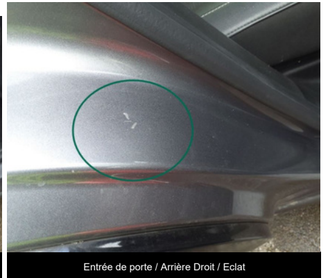
Entrée de porte / Arrière Droit / Eclat
