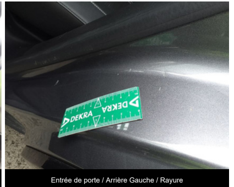
Entrée de porte / Arrière Gauche / Rayure
