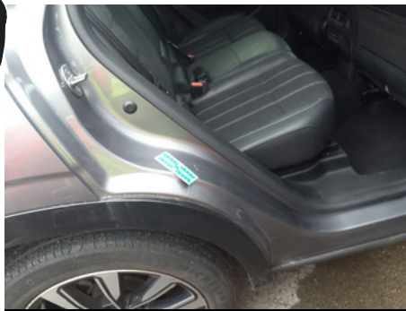
Entrée de porte / Arrière Droit / Eclat
