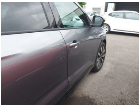
Porte / Avant Droit / Enfoncement
