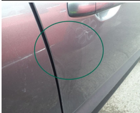
Porte / Avant Droit / Enfoncement
