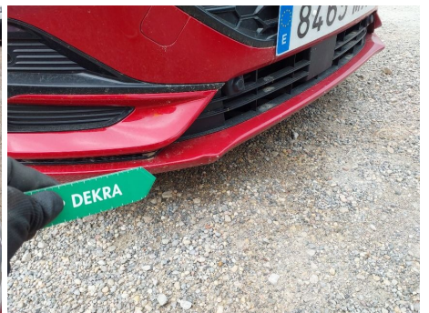
Paragolpes / Delantero / Abolladura
