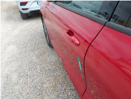
Puerta / Delantero Izquierdo / Abolladura
