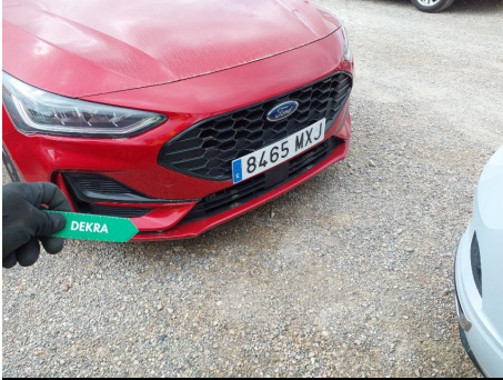
Paragolpes / Delantero / Abolladura
