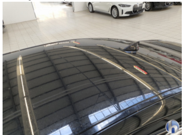
5. Dach 2 Dellen - Sanft Instandsetzen
