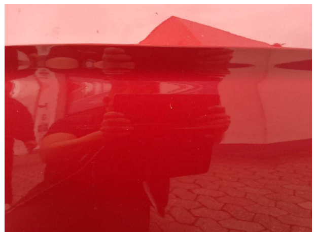
Beschädigung #5: Tür hinten rechts: Tür - Kratzer - lackieren
