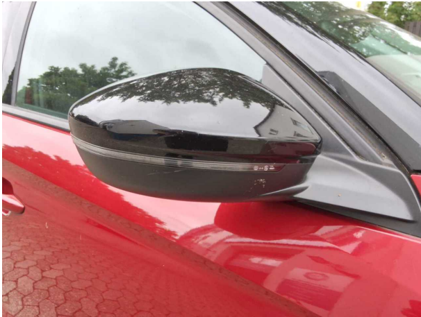
Beschädigung #1: Außenspiegel rechts: Abdeckkappe - Kratzer - Smart Repair
