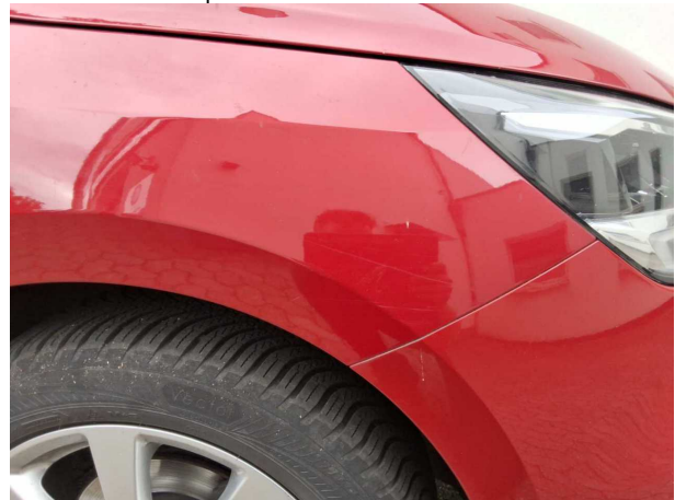
Beschädigung #3: Kotflügel rechts: Kotflügel rechts - Kratzer - lackieren
