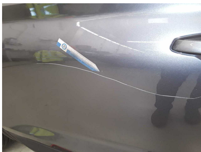
Damage 9: Door - front left side: Door (Gewaltschaden) - Scratch(es) - Repair and paint
