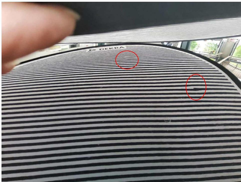
Bild 29 : Dach. mehrfach gedellt und Umweltschäden
