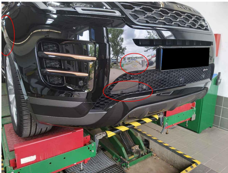
Bild 14 : Stoßfänger vorn verformt, Untere Gitter gebrochen, erneuern
