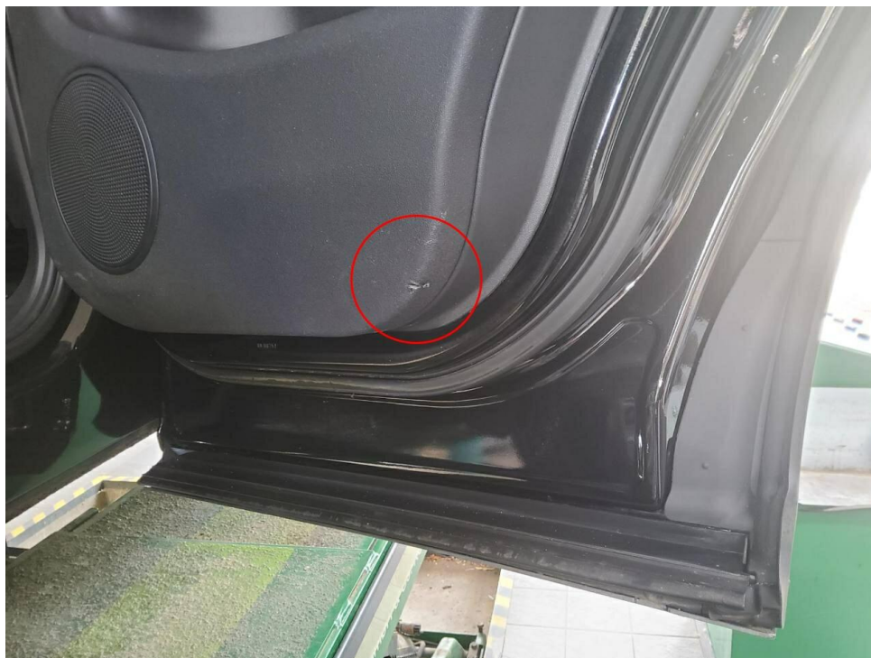
Bild 41 : Verkleidung Tür hinten rechts, gerissen, smart repair
