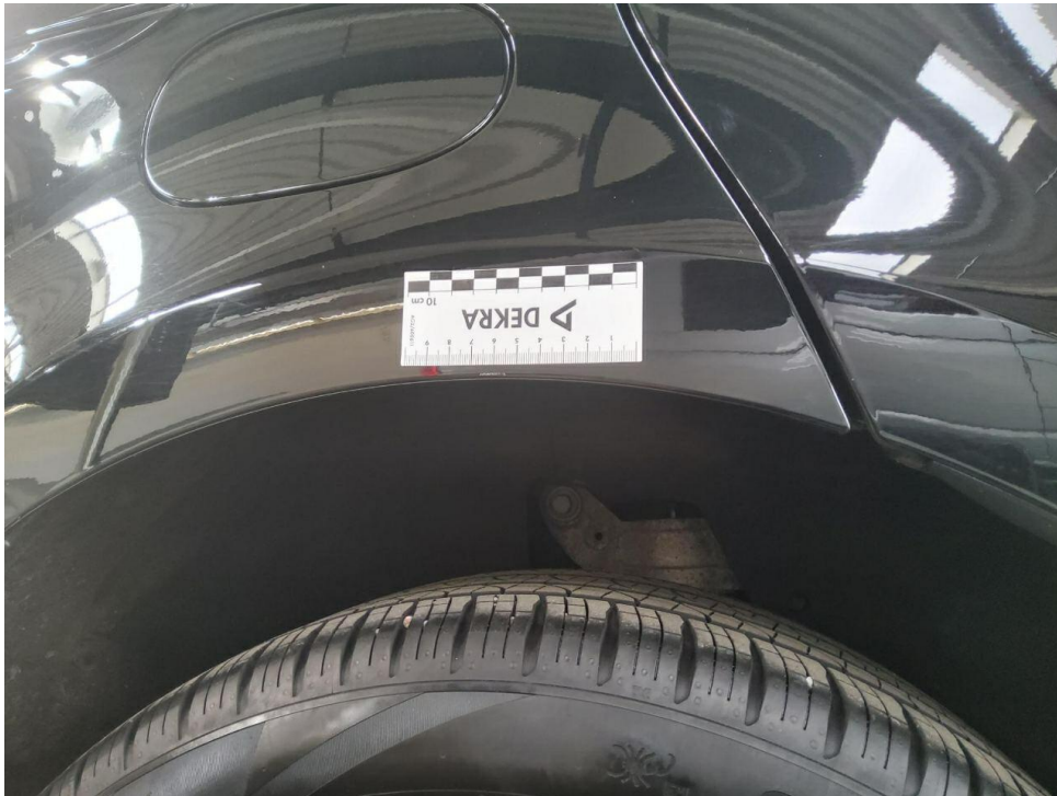
Bild 57 : Seitenteil hinten rechts Lackierung, verschrammt, Gebrauchsspur
