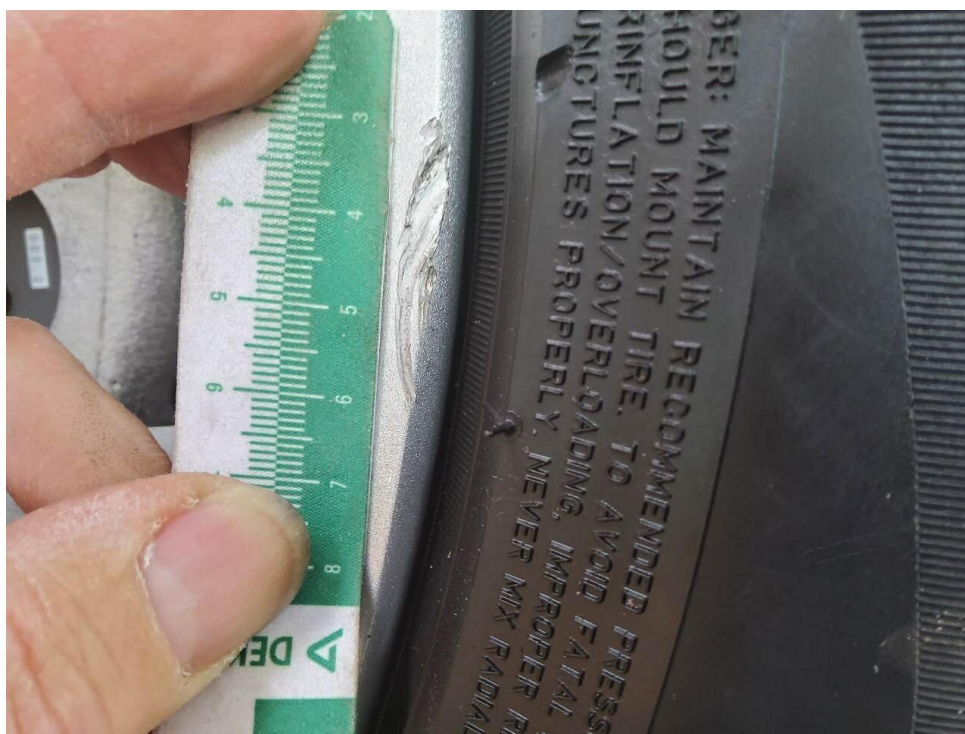
Bild 34 : Felge vorne rechts, zerkratzt, smart repair
