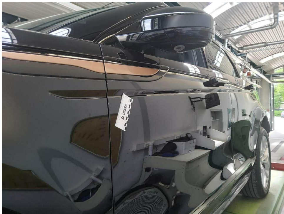
Bild 51 : Tür vorne links Lackierung, zerkratzt, lackieren
