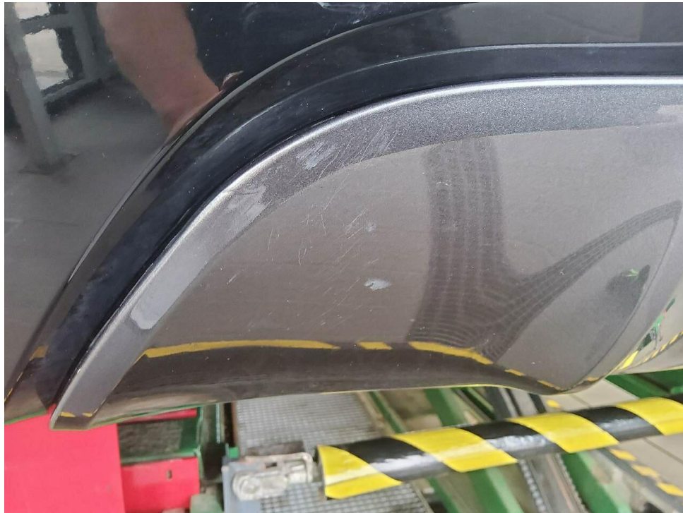
Bild 21 : Stoßfänger vorn verformt, Untere Gitter gebrochen, erneuern
