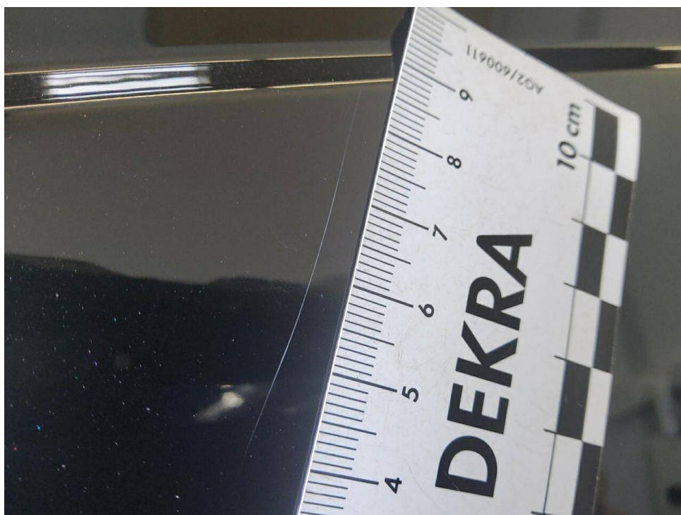
Bild 52 : Tür vorne links Lackierung, zerkratzt, lackieren
