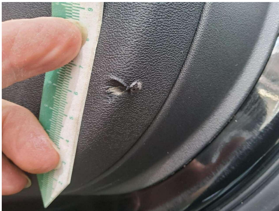
Bild 42 : Verkleidung Tür hinten rechts, gerissen, smart repair
