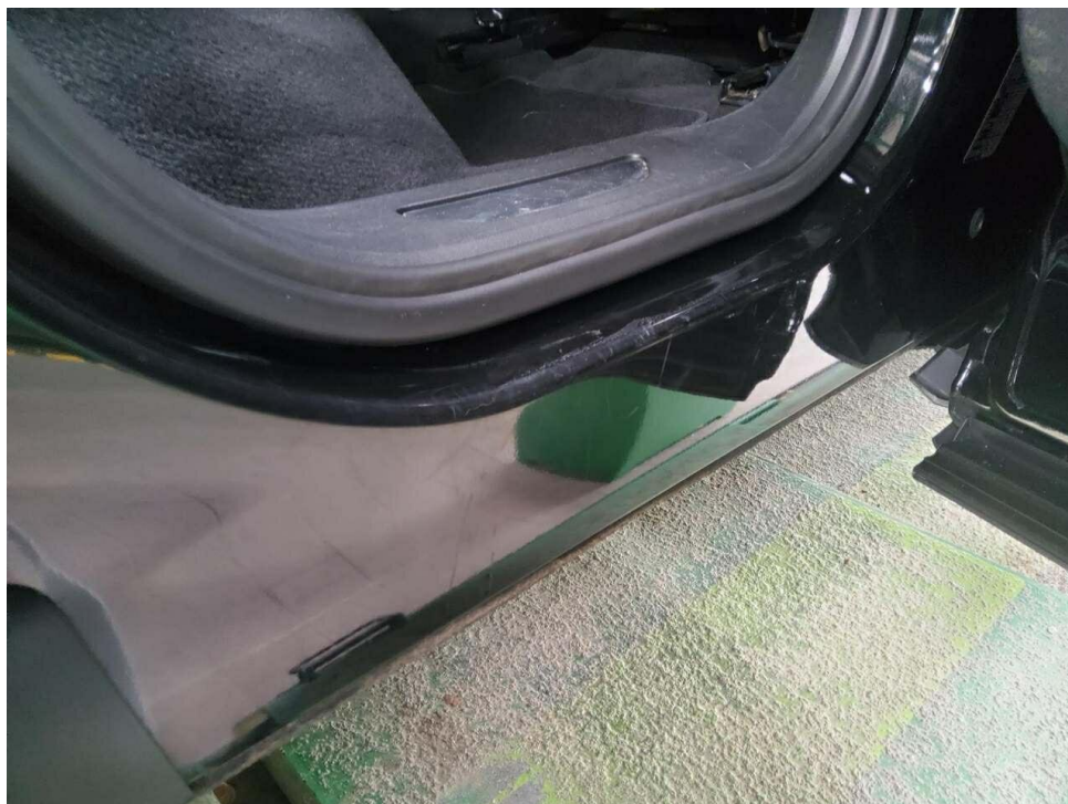
Bild 56 : Tür hinten rechts Einstieg Lackierung, verschrammt, Gebrauchsspur
