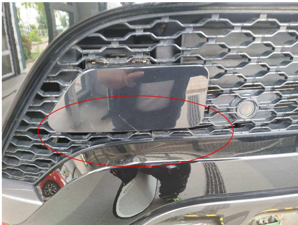
Bild 19 : Stoßfänger vorn verformt, Untere Gitter gebrochen, erneuern
