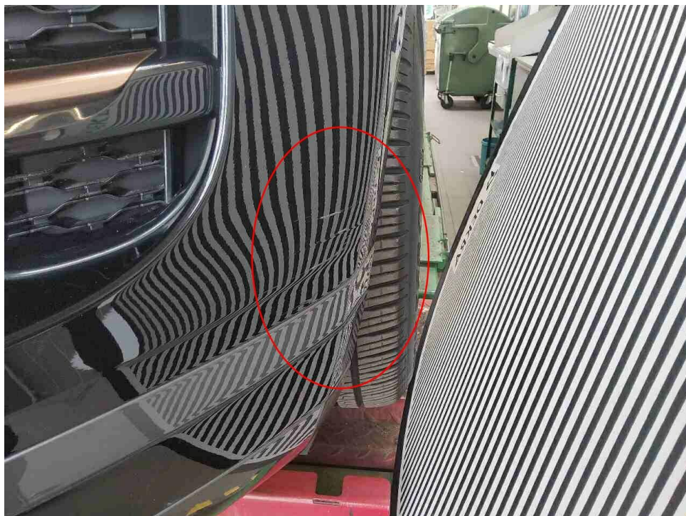
Bild 16 : Stoßfänger vorn verformt, Untere Gitter gebrochen, erneuern
