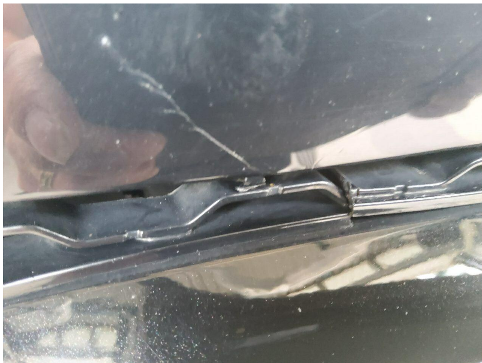
Bild 20 : Stoßfänger vorn verformt, Untere Gitter gebrochen, erneuern
