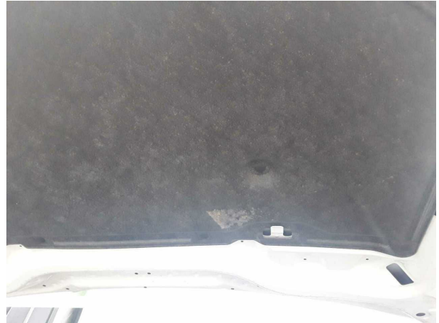
Beschädigung #1: Motorhaube: Dämmmatte - Marderschaden - erneuern
