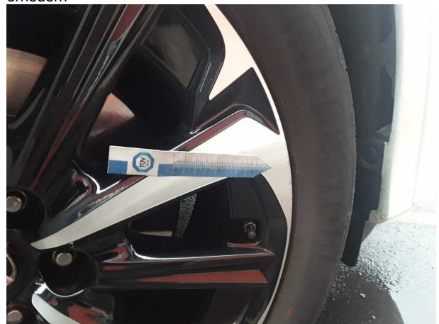
Beschädigung #2: Rad/Reifen: Leichtmetallfelge vorn rechts - Kratzer - Wertminderung
