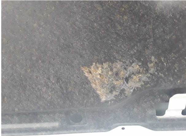
Beschädigung #1: Motorhaube: Dämmmatte - Marderschaden - erneuern
