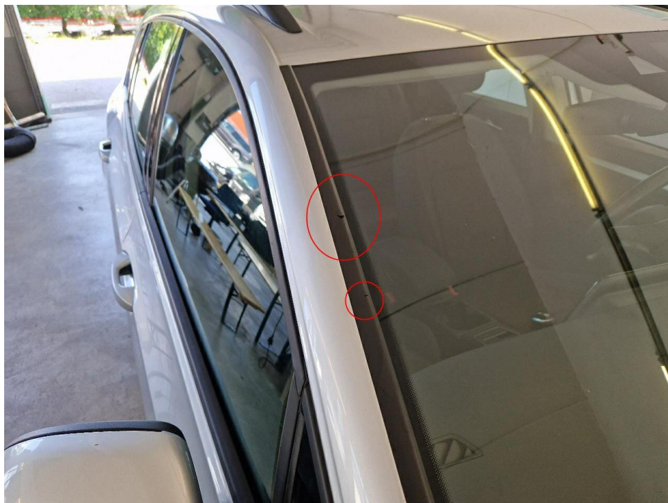
Bild 14 : Wasserabweißer rechts kratzer
