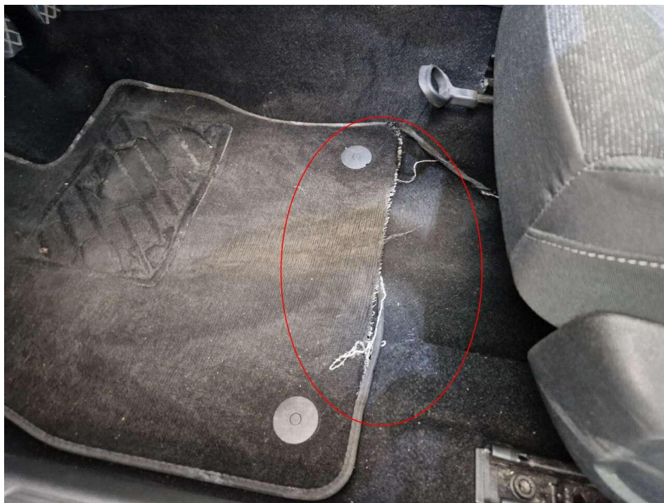
Bild 16 : Fußmatte vorn links gerissen
