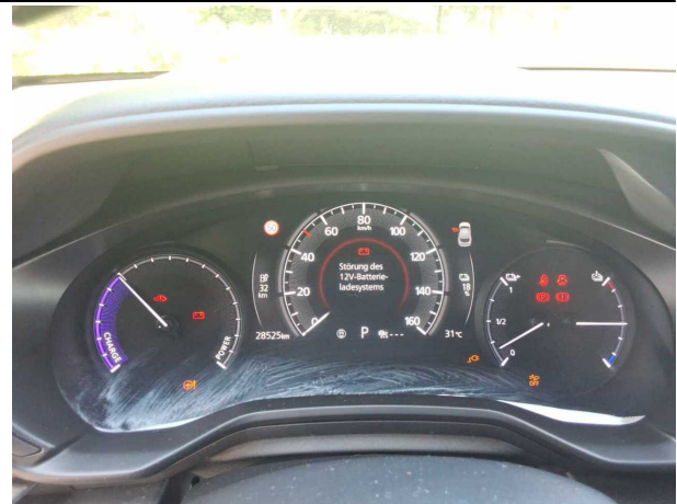
Beschädigung #2: Instrumententafel: Kombiinstrument - leuchtet - befunden ggf. instandsetzen
