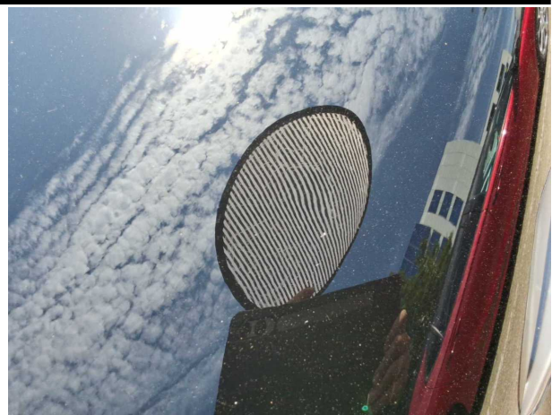
Beschädigung #2: Motorhaube: Motorhaube - Delle(n) - sanft instandsetzen
