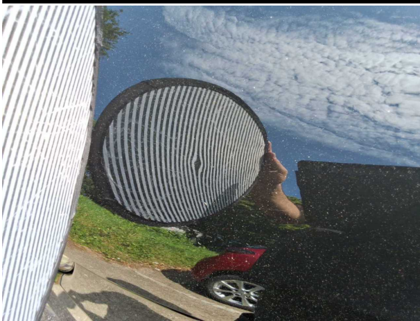
Beschädigung #2: Motorhaube: Motorhaube - Delle(n) - sanft instandsetzen
