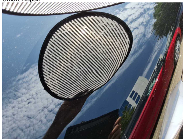
Beschädigung #2: Motorhaube: Motorhaube - Delle(n) - sanft instandsetzen
