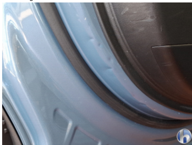
2. Tür Vorne - Links Beschädigt - Smart Repair
