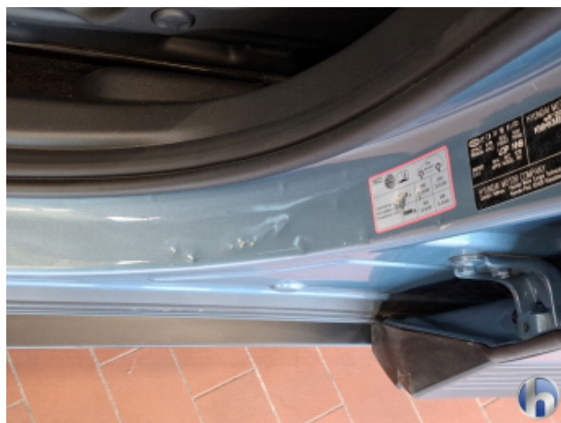
1. Türeinstieg Vorne - Links Beschädigt - Instandsetzen und Lackieren
