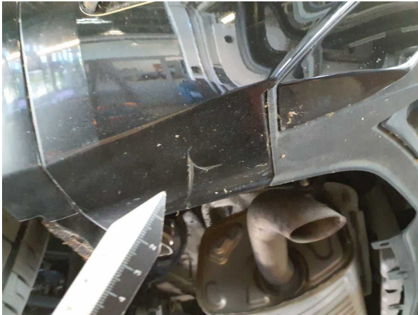
Beschädigung #1: Stossfänger hinten: Stossfänger hinten - verkratzt / verschürft - Smart Repair
