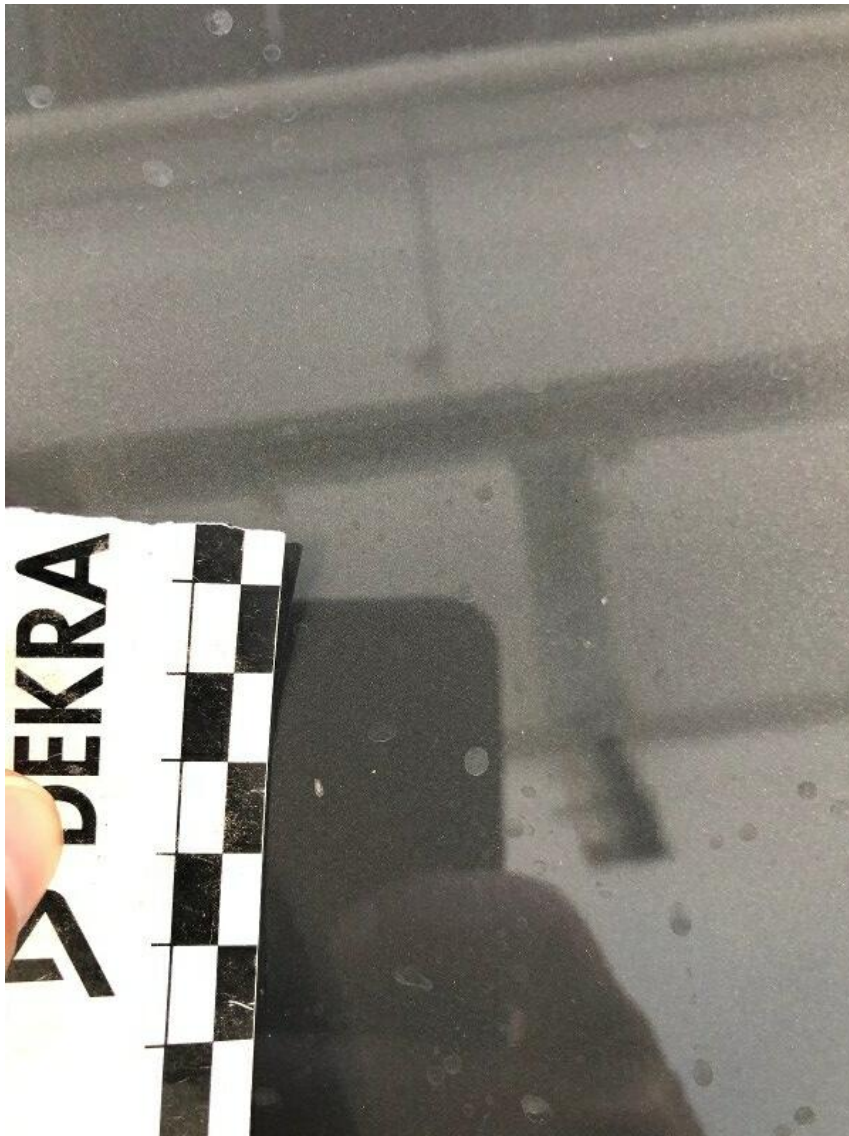
Bild 22 : Fahrzeugfront div. laufleistungsbedingte Steinschläge
