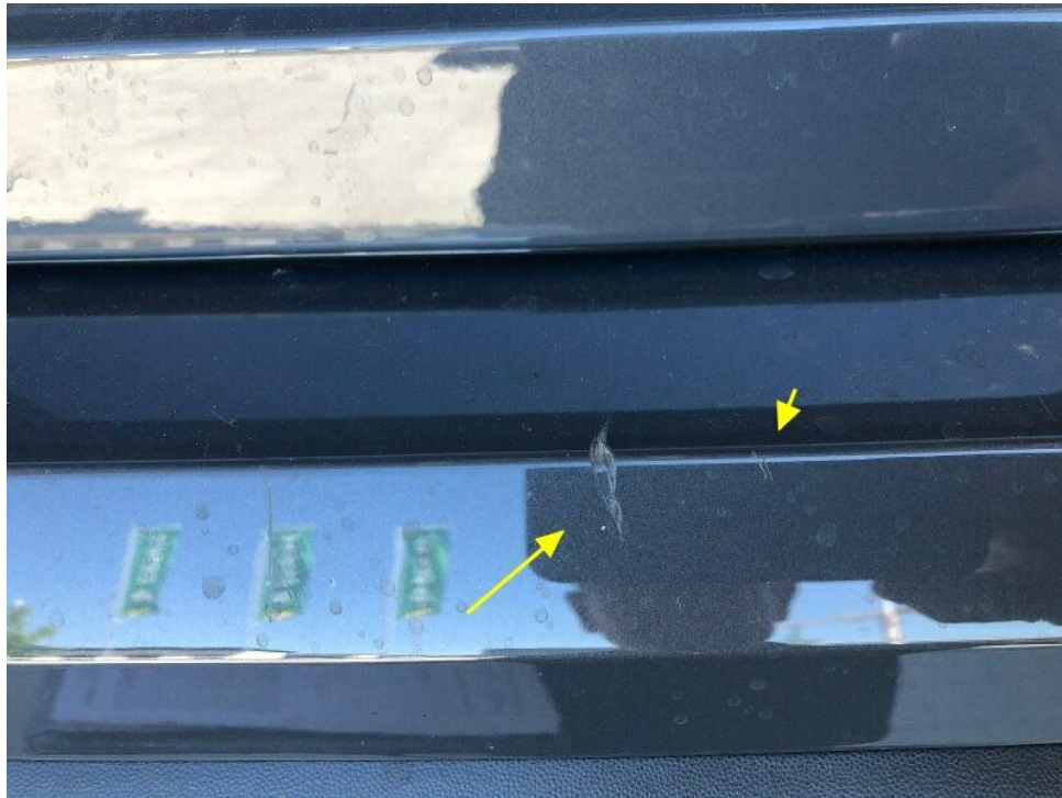
Bild 26 : Stoßfänger hinten Lackierung, verschrammt, smart repair
