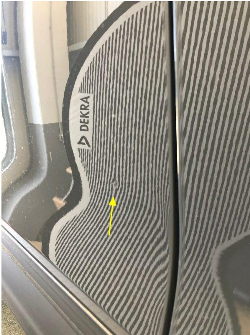
Bild 25 : Tür hinten rechts, eingedellt, Gebrauchsspur
