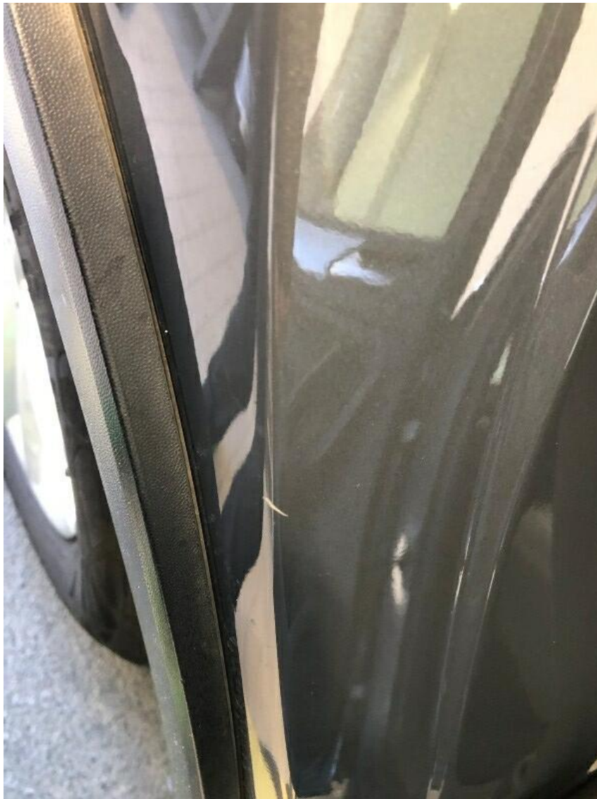
Bild 16 : Tür hinten rechts Einstieg Lackierung, verschrammt, Gebrauchsspur
