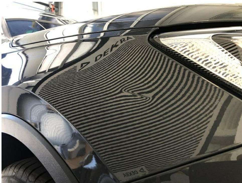
Bild 23 : Kotflügel vorne rechts, eingedellt, instandsetzen und lackieren mit Lackaufbau
