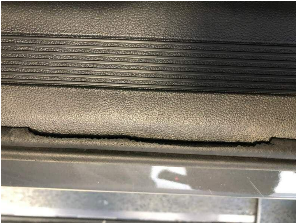
Bild 15 : Dichtung Tür vorne links gerissen
