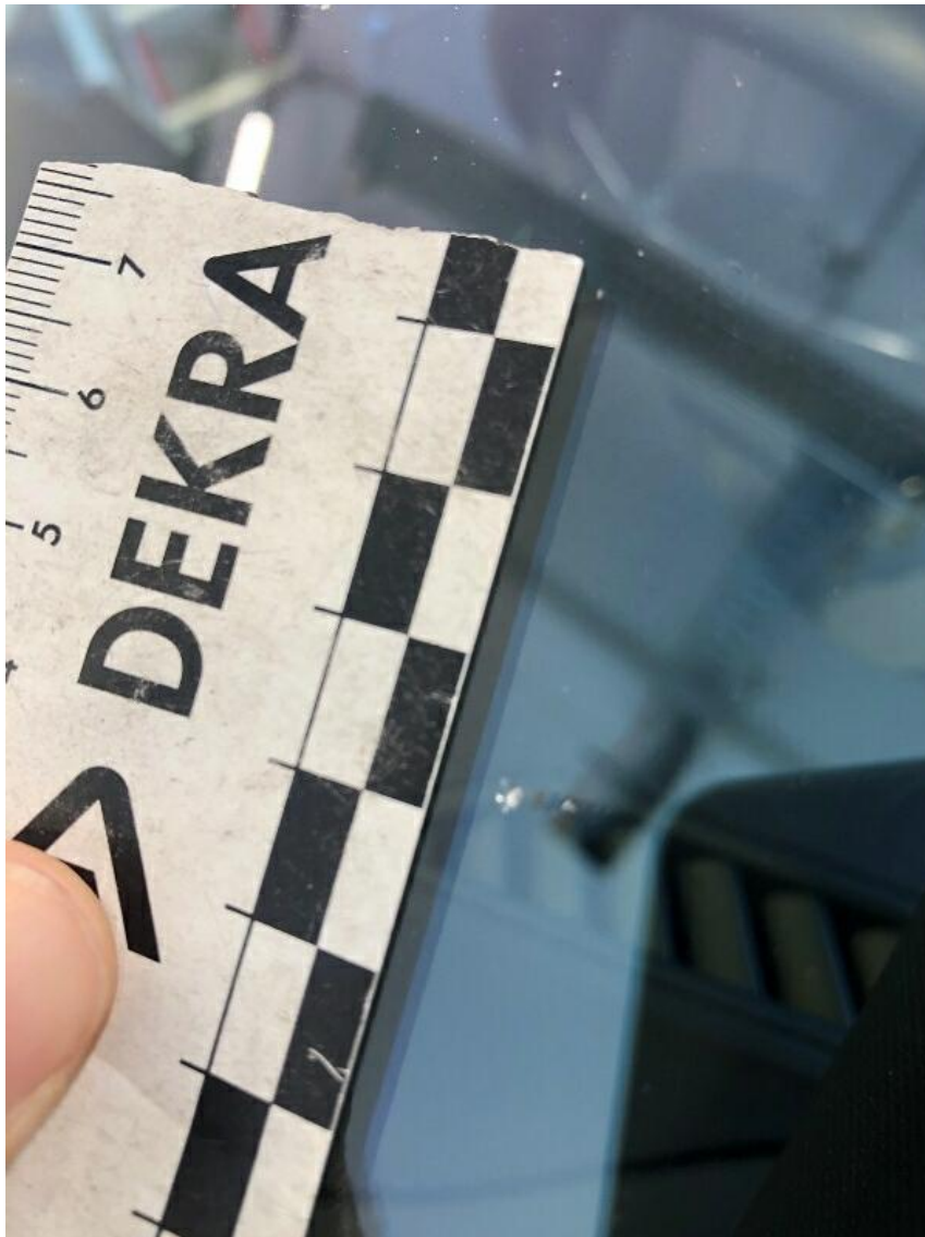
Bild 21 : Fahrzeugfront div. lauffleistungsbedingte Steinschläge
