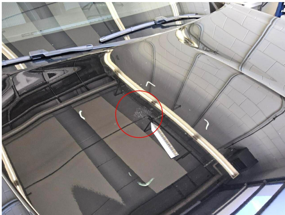
Bild 16 : Motorhaube Lackierung, Umweltschaden, lackieren mit Lackaufbau
