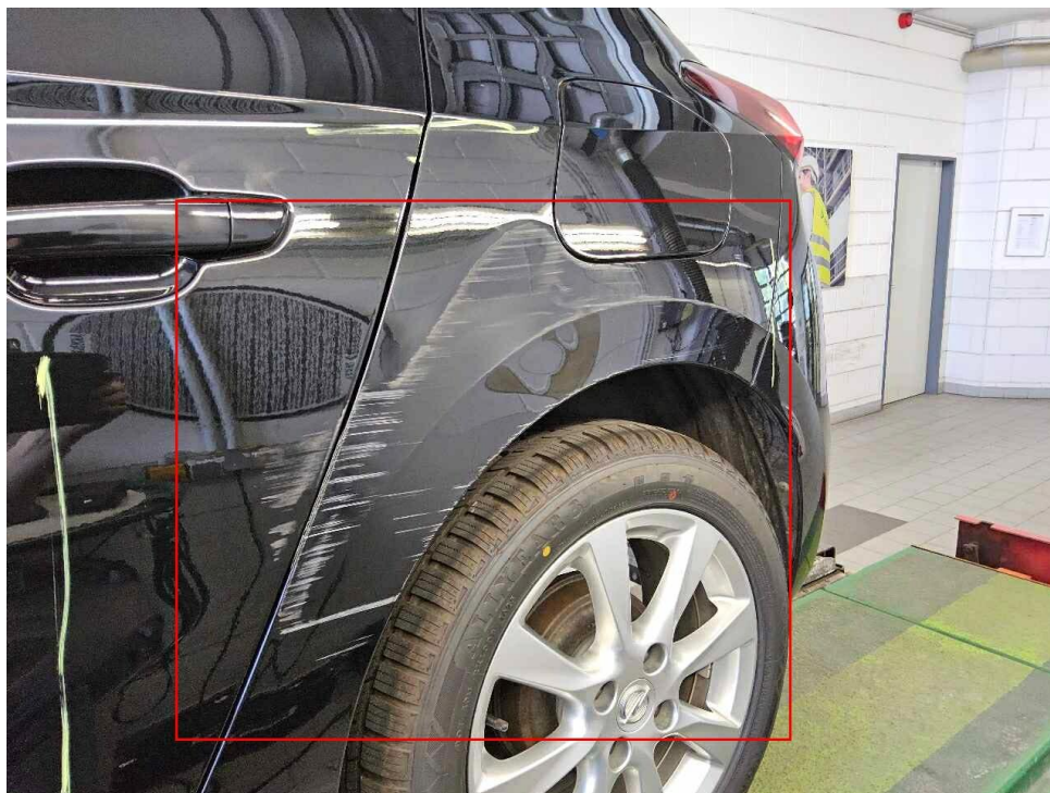
Bild 13 : Streifschaden hinten links (umfasst Tür hinten und Seitenwand)
