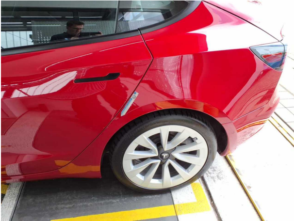
Beschädigung #1: Seitenwand links: Seitenwand - Delle(n) - sanft instandsetzen
