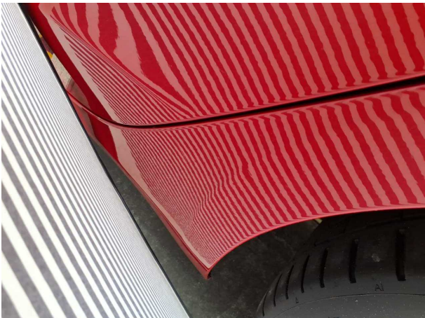
Beschädigung #1: Seitenwand links: Seitenwand - Delle(n) - sanft instandsetzen
