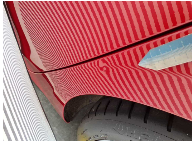
Beschädigung #1: Seitenwand links: Seitenwand - Delle(n) - sanft instandsetzen
