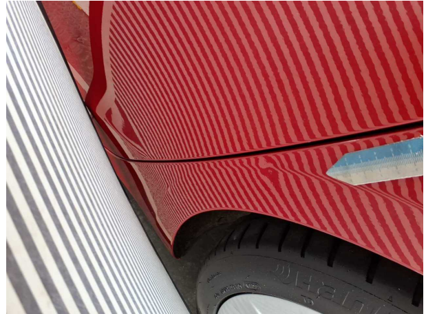
Beschädigung #1: Seitenwand links: Seitenwand - Delle(n) - sanft instandsetzen
