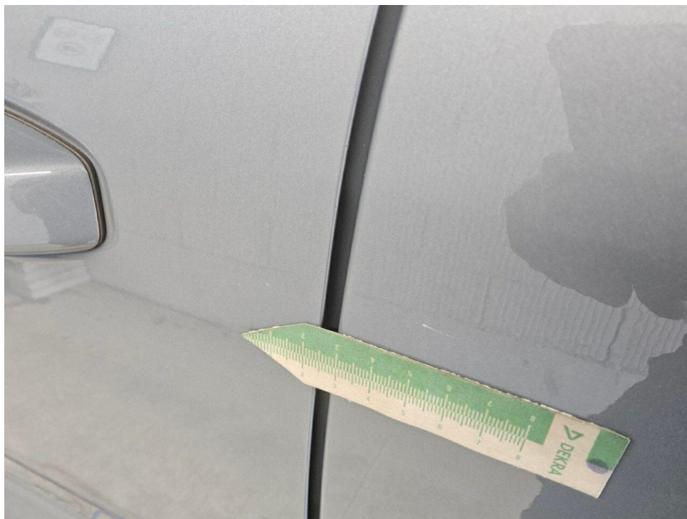
Bild 21 : Tür hinten links Lackierung, zerkratzt, Gebrauchsspur
