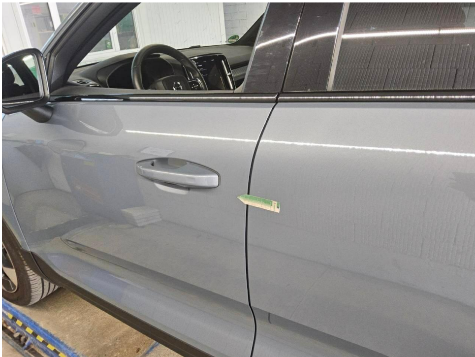
Bild 20 : Tür hinten links Lackierung, zerkratzt, Gebrauchsspur
