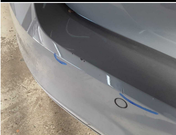
Beschädigung #3: Stossfänger hinten: Stossfänger hinten - verkratzt / verschürft - Smart Repair
