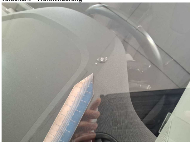
Beschädigung 4: Verglasung: Frontscheibe - Steinschlag - erneuern
