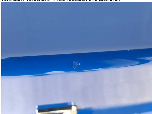
Beschädigung 6: Heckklappe/-tür: Heckklappe - verkratzt / verschürft - instandsetzen und lackieren
