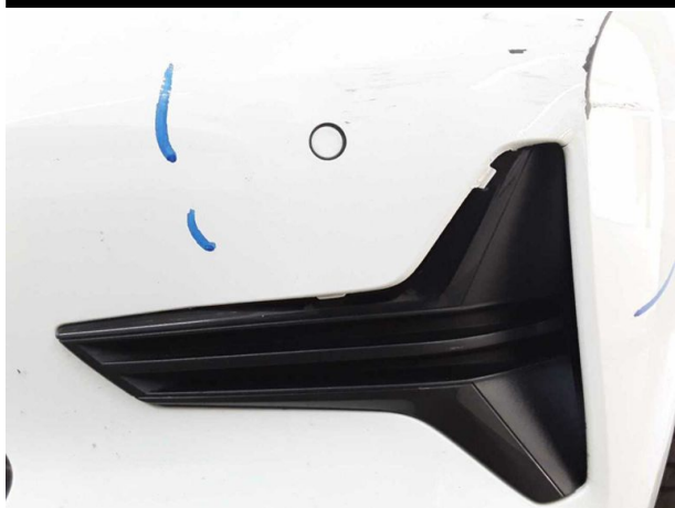
Beschädigung #4: Verkleidungen/Abdeckungen: Verkleidungen/Abdeckungen (Leiste) - verkratzt / verschürft - erneuern
