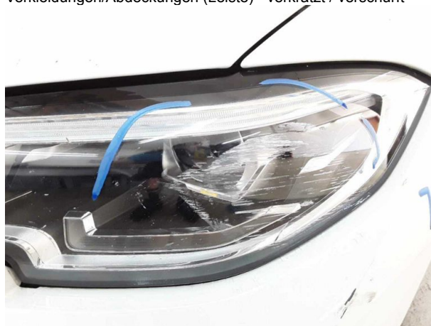
Beschädigung #5: Scheinwerfer: LED-Scheinwerfer rechts - verkratzt / verschürft - erneuern
