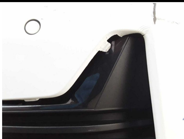
Beschädigung #4: Verkleidungen/Abdeckungen: Verkleidungen/Abdeckungen (Leiste) - verkratzt / verschürft -
