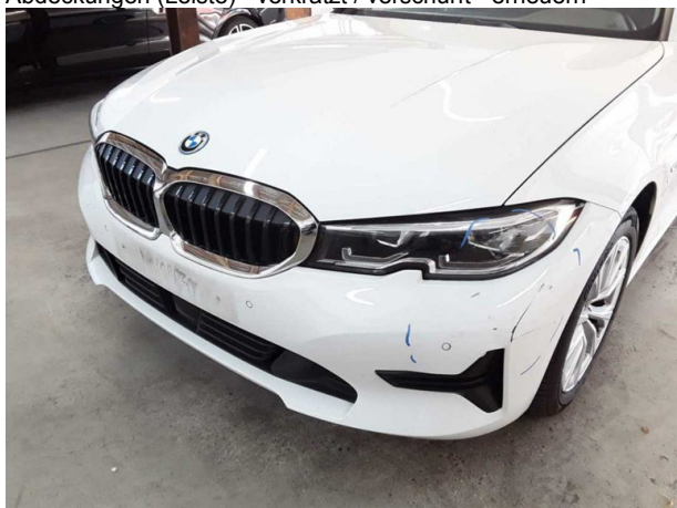
Beschädigung #5: Scheinwerfer: LED-Scheinwerfer rechts - verkratzt / verschürft - erneuern
