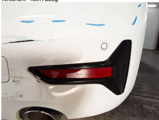
Beschädigung #3: Verkleidungen/Abdeckungen: Verkleidungen/Abdeckungen (Leiste) - verkratzt / verschürft - erneuern
