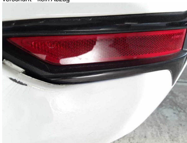
Beschädigung #3: Verkleidungen/Abdeckungen: Verkleidungen/Abdeckungen (Leiste) - verkratzt / verschürft -
