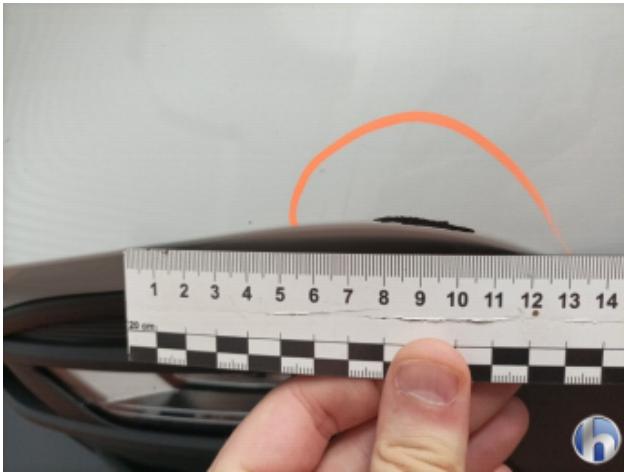
4. Stoßfänger Vorne Kratzer - Smart Repair
