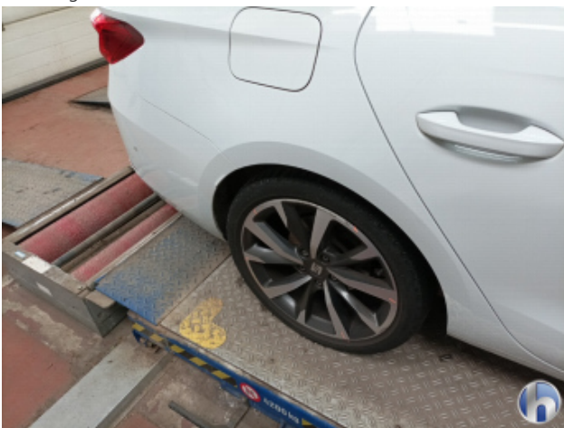
1. Felge Hinten - Rechts Beschädigt - Smart Repair
